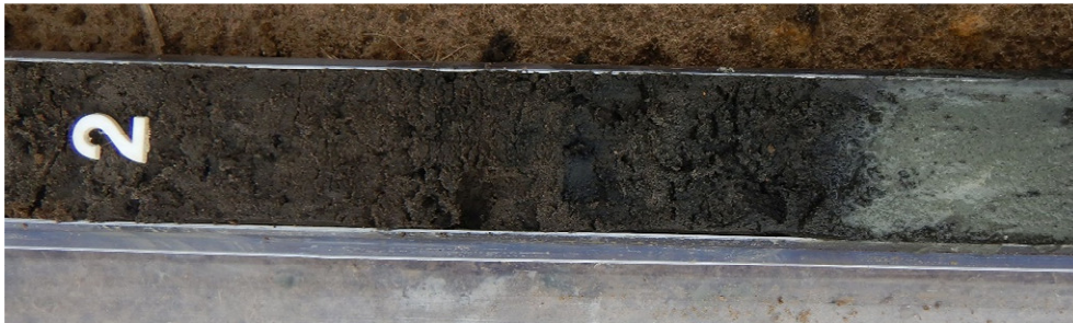
Figuur 8. Detailopname van het organisch laagje in boring 2, op een diepte van 4,50 meter onder het maaiveld.
