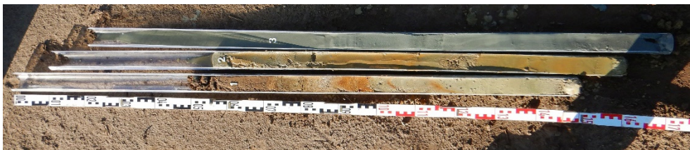
Figuur 6. Terreinopname van boring 6.
