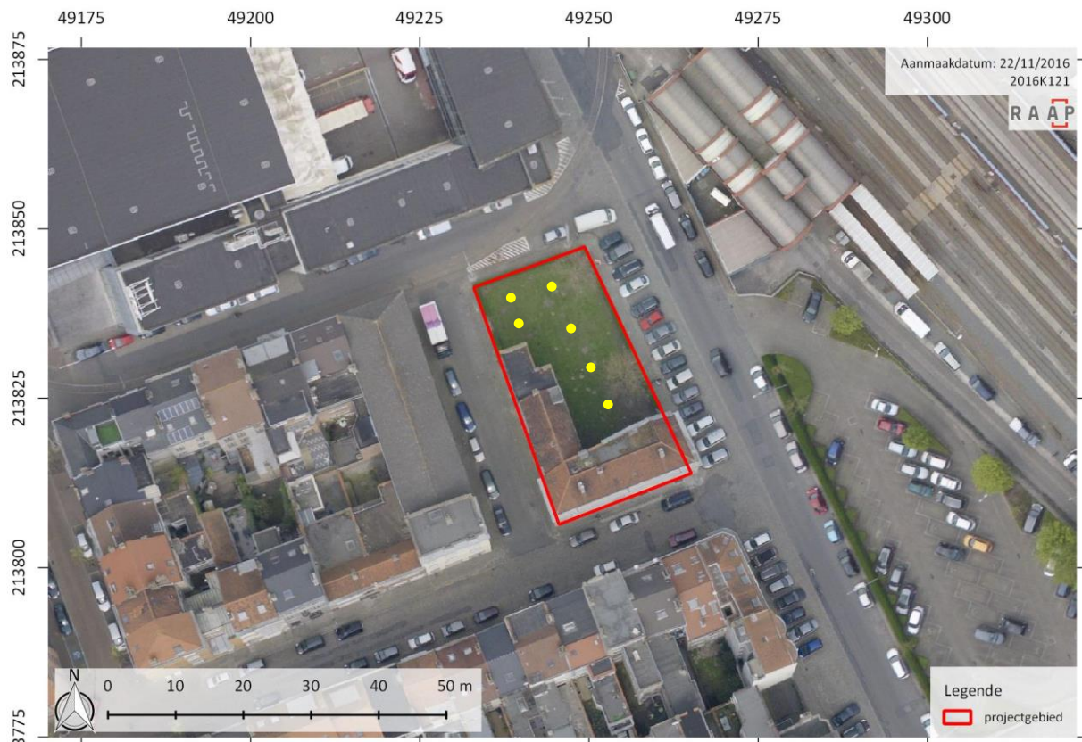
Figuur 2 Boorpuntenplan met minimum aantal boringen.
