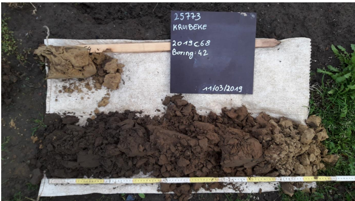
Figuur 5: Boorprofiel van boring 42 als typevoorbeeld voor een Ap-B-C-profiel.
