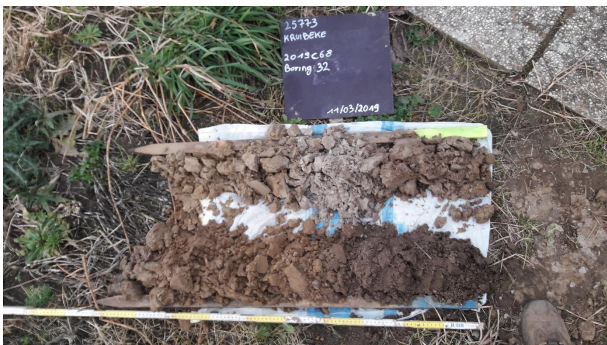
Figuur 7: Boorprofiel van boring 32 als typevoorbeeld voor een Ap-B-Bt-C-profiel.
