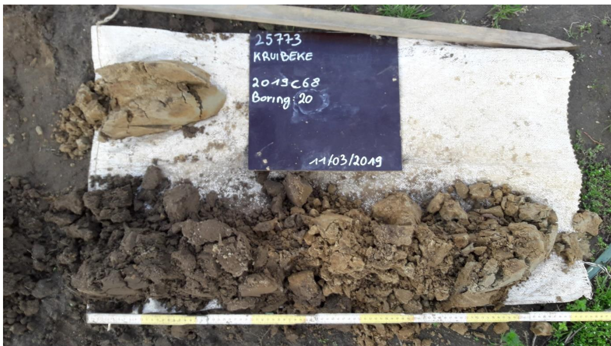
Figuur 6: Boorprofiel van boring 20 als typevoorbeeld voor een Ap-B/C-C-profiel.
