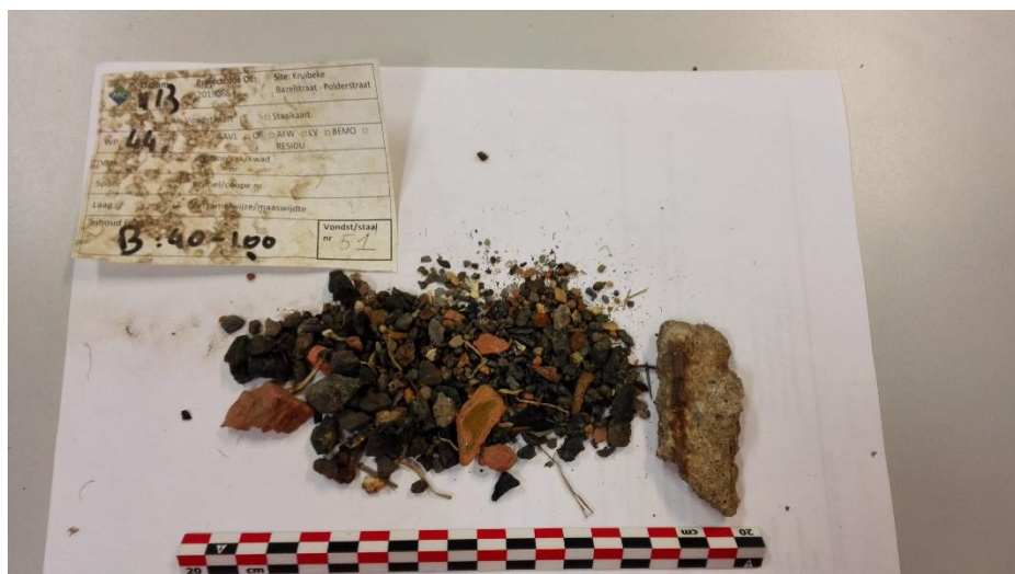
Figuur 9: Zeefresidu met steenkool, baksteen, grind, bot, aardewerkfragment en gewapend beton uit de B-horizont van boring 44 (ABO nv 2019)
