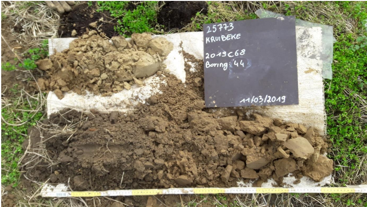
Figuur 4: Boorprofiel van boring 44 als typevoorbeeld voor een Ap-C-profiel.
