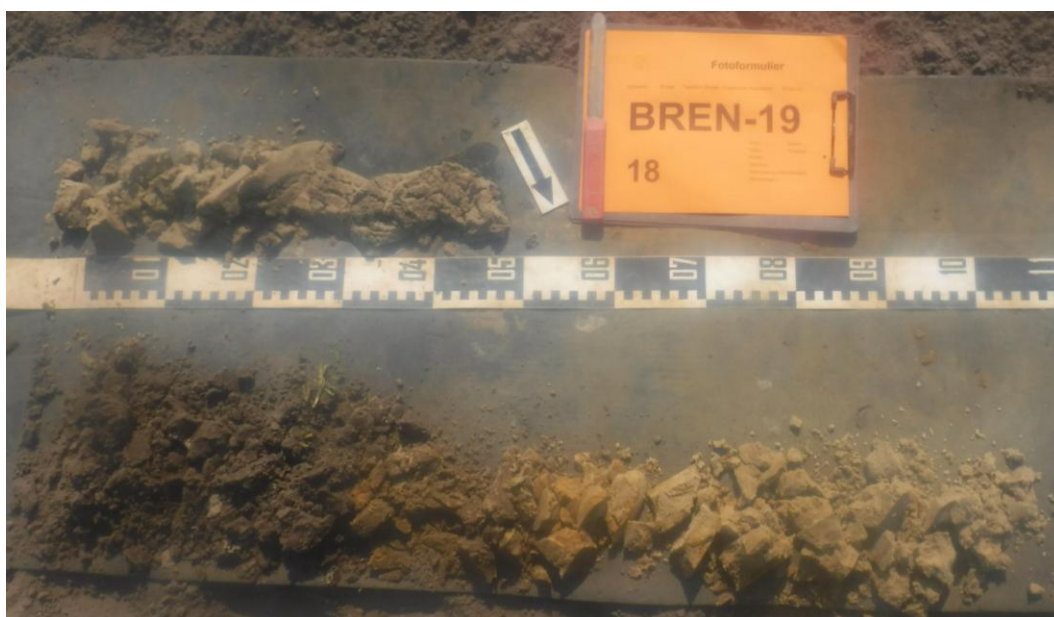
Afb. 50. Foto van boring 18, uitgelegd van linksonder naar rechtsboven. 0-30 cm: laag 1; 30-50 cm: laag 10; 50-150 cm (e.b.): laag 8.
