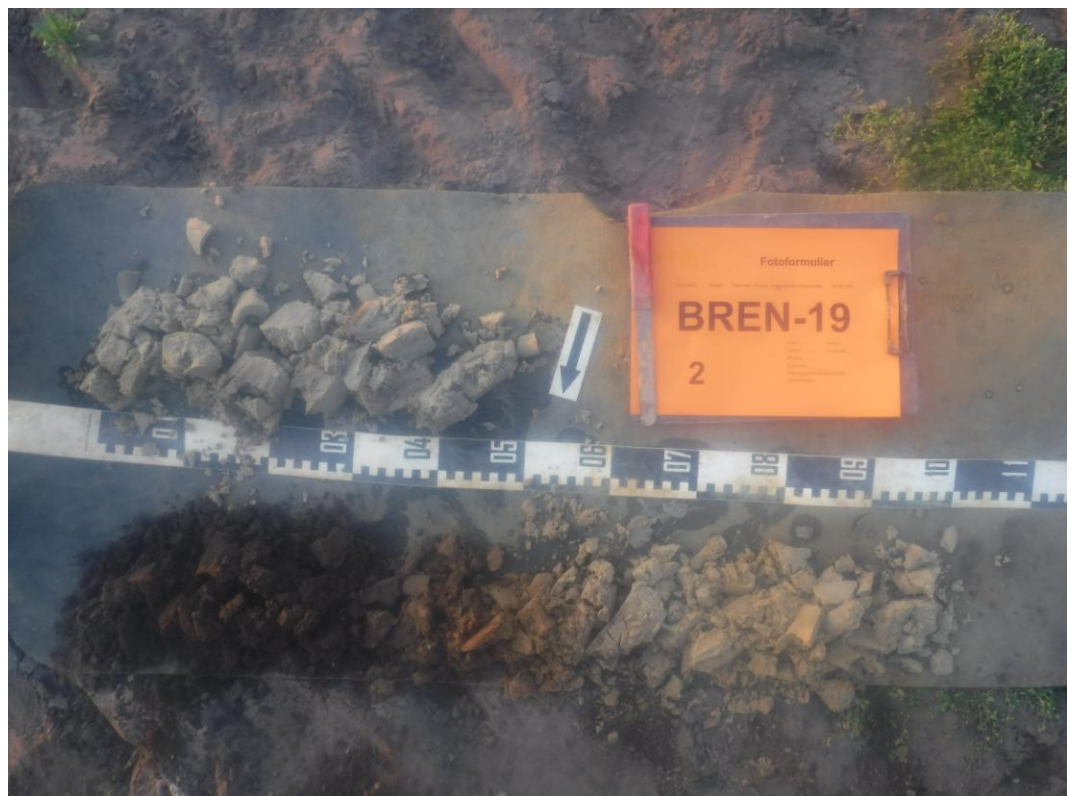
Afb. 52. Foto van boring 2, uitgelegd van linksonder naar rechtsboven. 0-30 cm: laag 1; 30-50 cm: laag 11; 50-60 cm: laag 6; 60-150 cm: laag 8.
