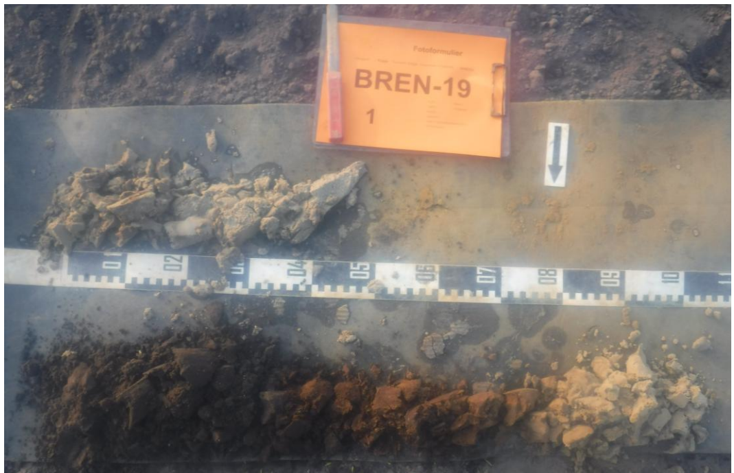
Afb. 48. Foto van boring 1, uitgelegd van linksonder naar rechtsboven. 0-30 cm: laag 1; 30-50 cm: laag 4; 50-70 cm: laag 6; 70-120 cm: laag 7; 120-150 cm (e.b.): laag 8.
