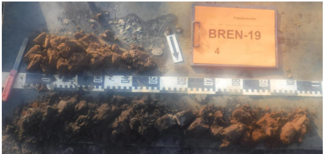
Afb. 47. Foto van boring 4, uitgelegd van linksonder naar rechtsboven. 0-40 cm: laag 1; 40-50 cm: laag 2; 50-55 cm: laag 3; 55-80 cm: laag 4; 80-100 cm: laag 5; 100-150 cm (e.b.): laag 6.
