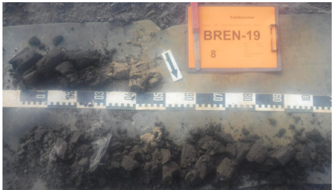
Afb. 51. Foto van boring 8, uitgelegd van linksonder naar rechtsboven. 0-30 cm: laag 1; 30-130 cm: laag 12; 130-150 cm (e.b.): laag 8.
