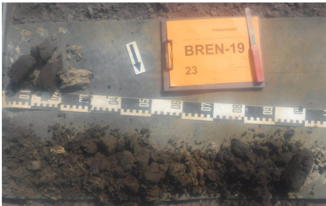
Afb. 49. Foto van boring 23, uitgelegd van linksonder naar rechtsboven. 0-30 cm: laag 1; 30-50 cm: laag 9; 50-70 cm: laag 13; 70-120 cm: laag 14; 120-130 cm (e.b.): laag 8.
