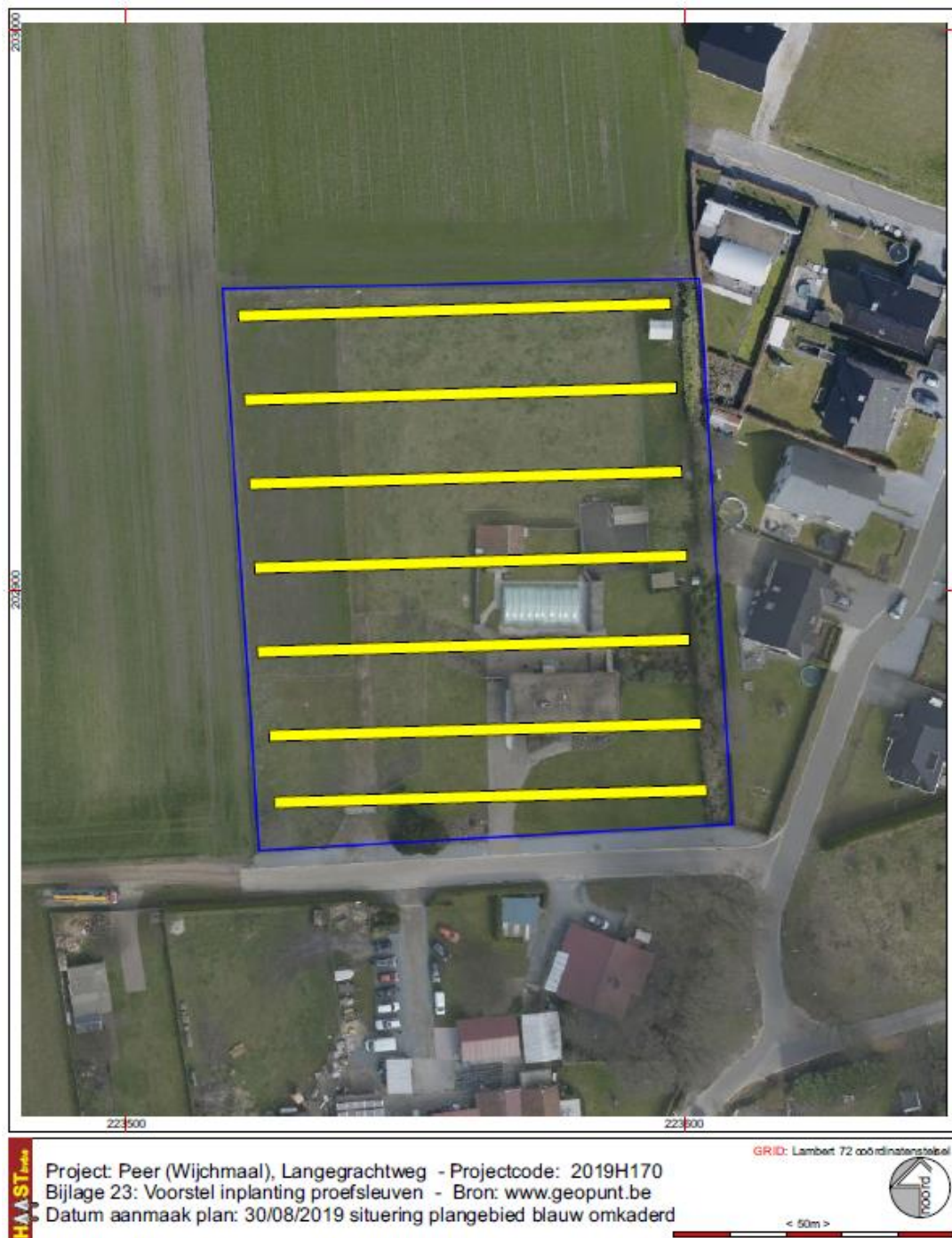
Fig. 29: Voorstel van inplanting van de proefsleuven
