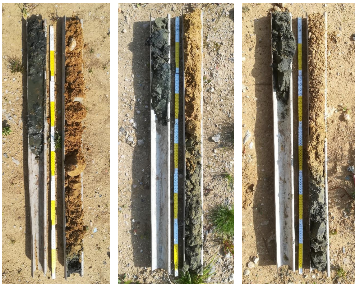
Figuur 11. Boringen 4 (links), 8 (midden) en 9 (rechts). Fragmenten modern bouwpuin werden tot onderin de boringen aangetroffen.
