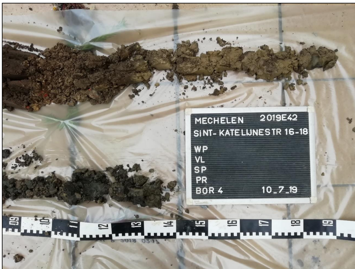
Figuur 36: Foto van boring 4 (detail 1), met boorinhoud rechtsboven tussen 90 en 200 cm en boorinhoud rechtsonder tussen 290 en 340 cm (Bron: ABO nv 2019).
