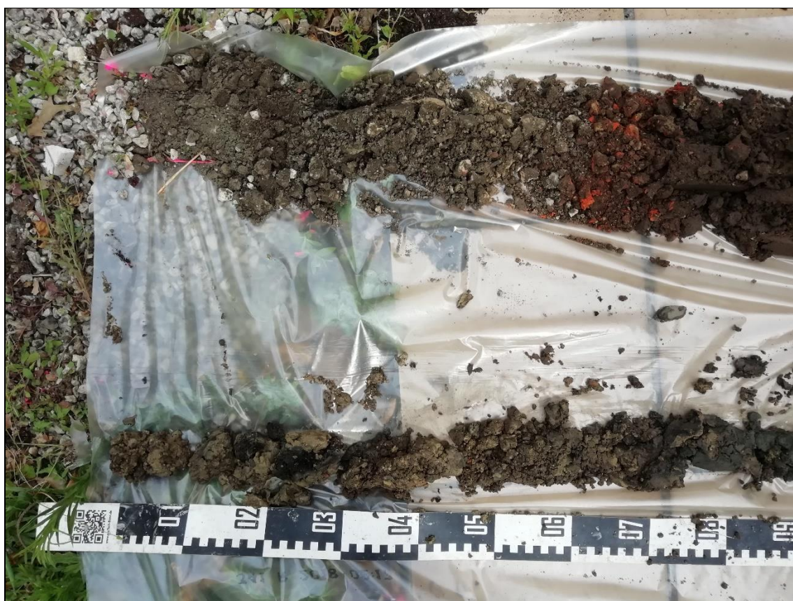
Figuur 35: Foto van boring 4 (detail 1), met boorinhoud linksboven tussen 0 en 90 cm en boorinhoud linksonder tussen 200 en 290 cm (Bron: ABO nv 2019).
