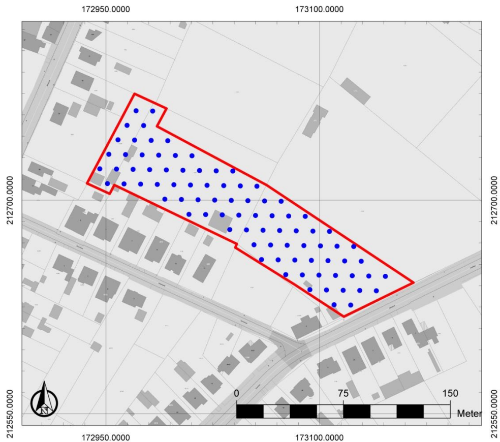
Figuur 4: Inplanting van de verkennende boringen (blauw)
