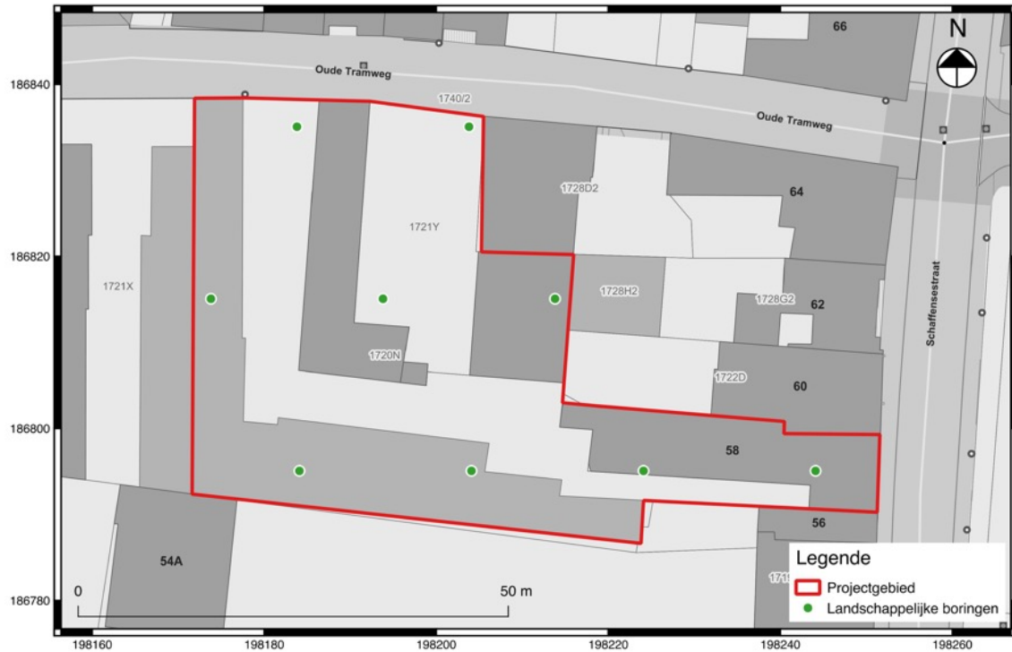
Fig. 2.5: Vooropgesteld boorpuntenplan bij het manueel landschappelijk booronderzoek.
