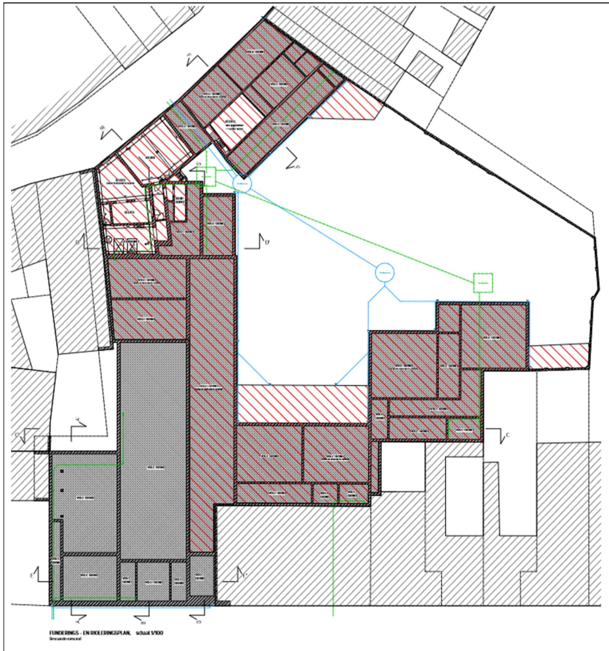
Figuur 3. Funderings- en rioleringsplan bestaande toestand.
