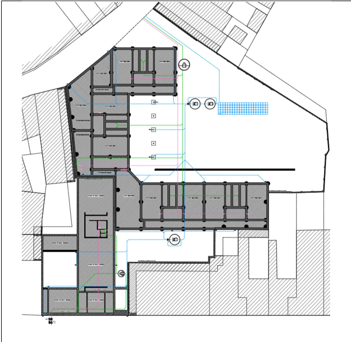
Figuur 7. Fundering- en rioleringsplan van de nieuwbouw.
