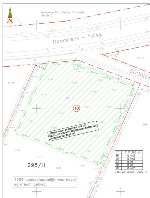
Figuur 14: Ontwerpplan terrein voor grondverbetering op perceel 298H (bron: Aquafin).
