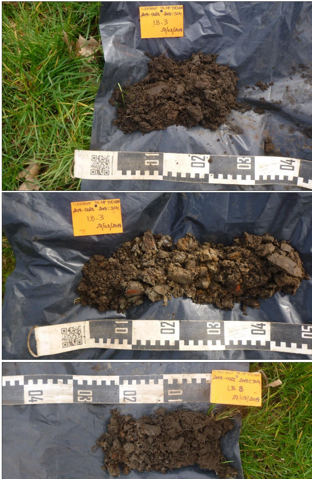
Figuur 28: Voorbeelden van de mislukte boringen ter plaatse en in de omgeving van de oorspronkelijk locatie van boorpunten 3 en 8. In alle gevallen stuikte de boorkop op ondiep gelegen ondoordringbare verharding.
