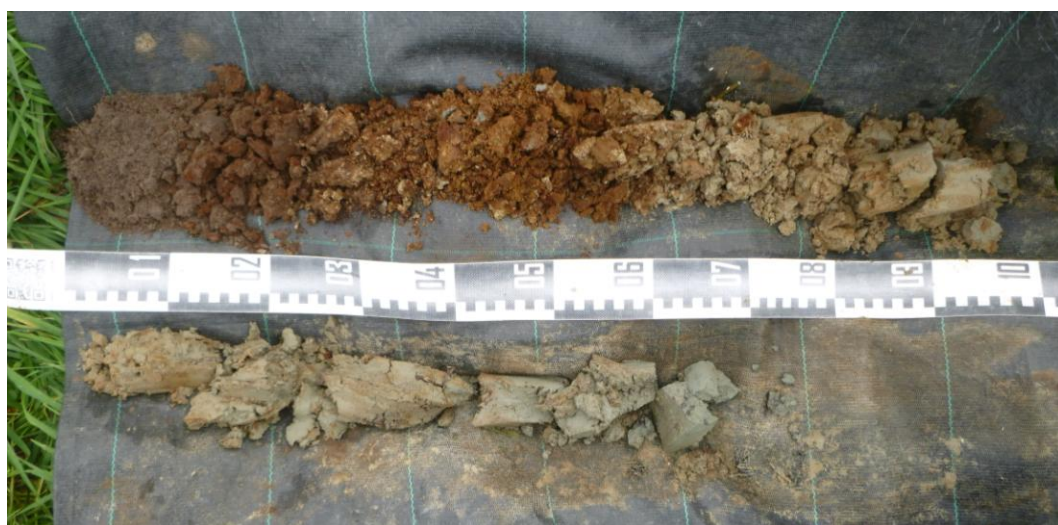
Afb. 17. Foto van boring BP4, uitgelegd van links naar rechts en van boven naar onder.
