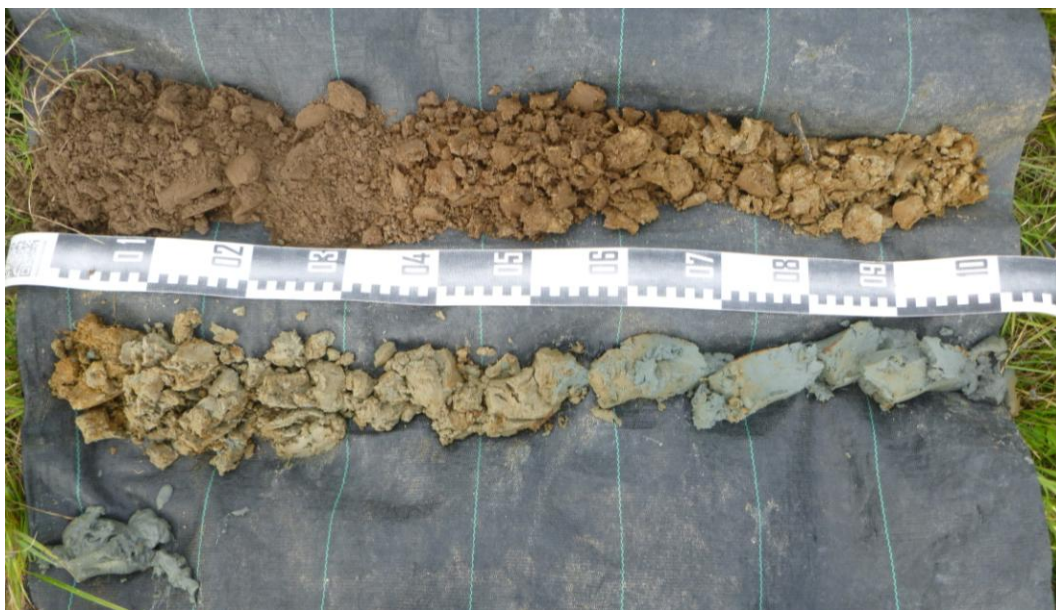
Afb. 15. Foto van boring BP1, uitgelegd van links naar rechts en van boven naar onder.
