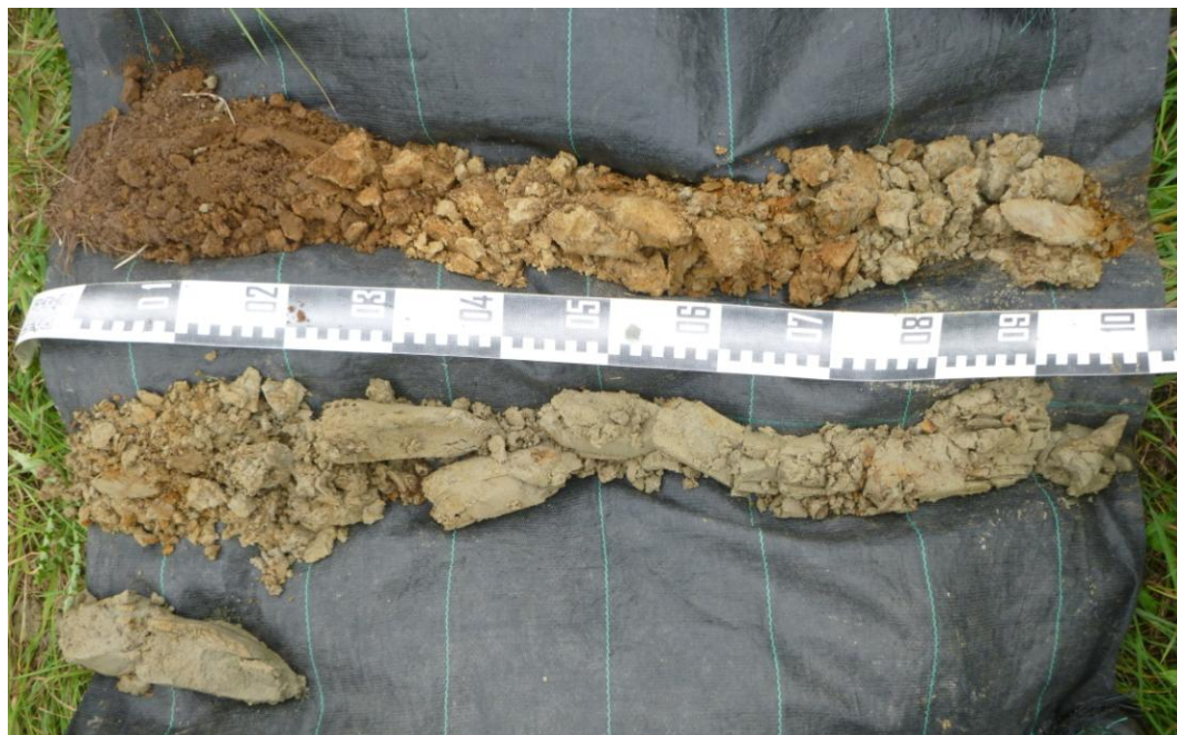
Afb. 18. Foto van boring BP5, uitgelegd van links naar rechts en van boven naar onder.
