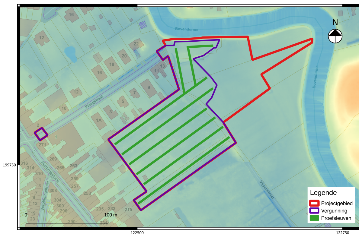
Fig. 2.5: Voorstel voor de aanleg van proefsleuven binnen het geplande vergunningsgebied.
