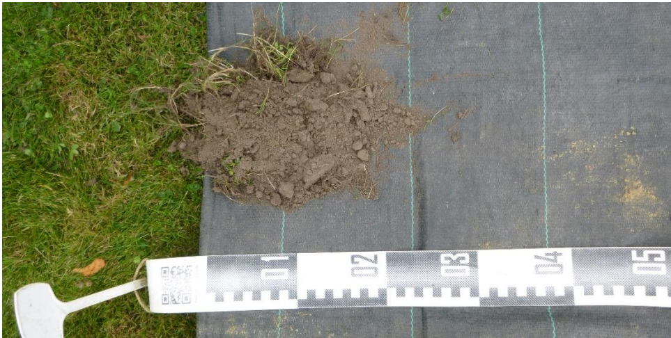
Figuur 53: Overzichtsfoto van boring BP24, uitgelegd van links naar rechts. Deze foto is representatief voor boringen BP23, BP24 en BP28.
