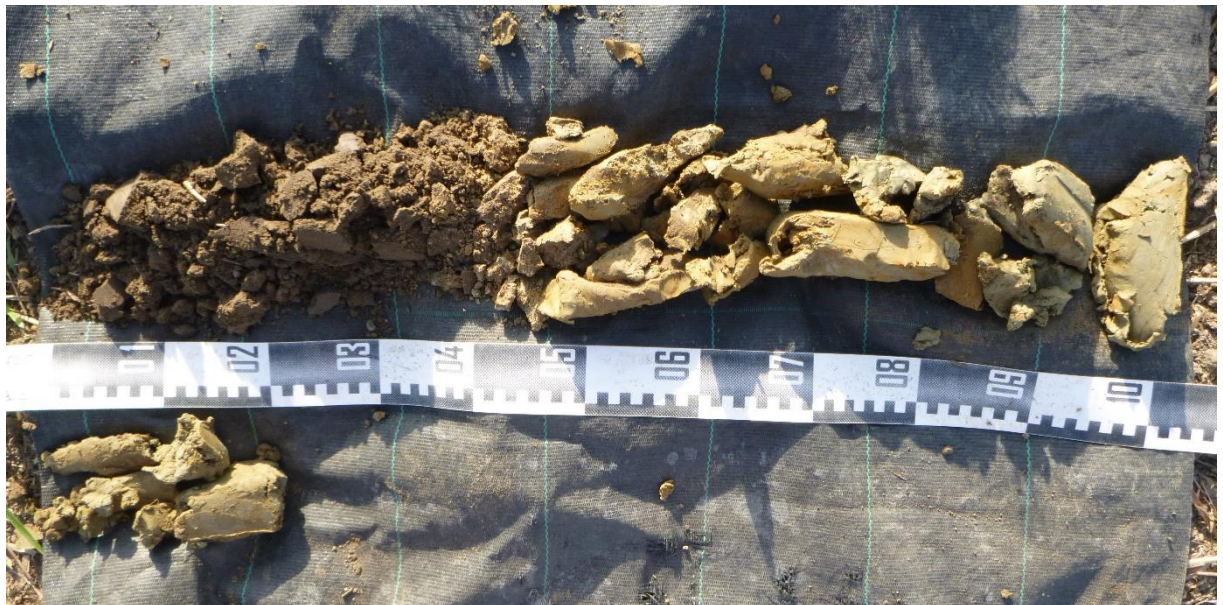
Figuur 39: Overzichtsfoto van boring BP1, uitgelegd van links naar rechts en van boven naar onder. Deze foto is representatief voor boringen BP1 en BP2.
