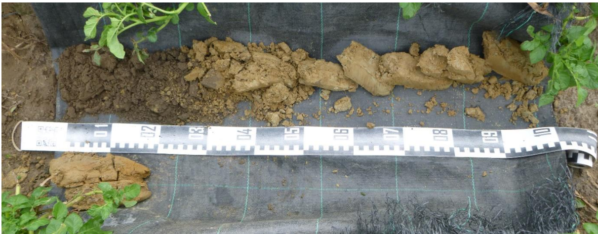
Figuur 45: Overzichtsfoto van boring BP17, uitgelegd van links naar rechts en van boven naar onder. Deze foto is representatief voor boringen BP10 en BP17.
