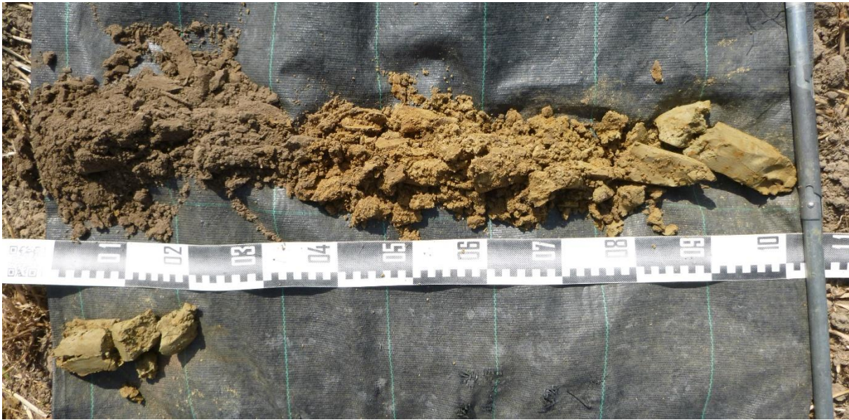
Figuur 40: Overzichtsfoto van boring BP6, uitgelegd van links naar rechts en van boven naar onder. Deze foto is representatief voor boringen BP3 t.e.m. BP9 en BP14.
