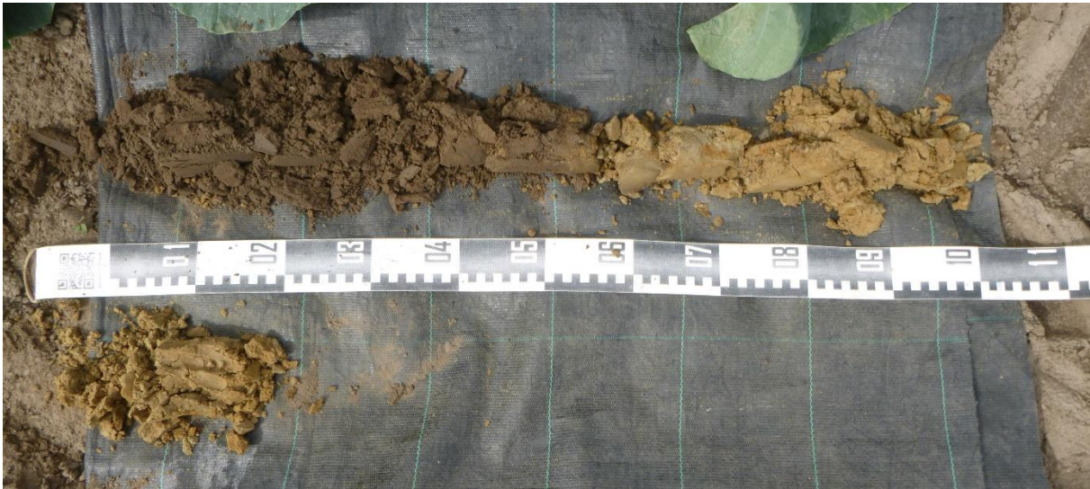
Figuur 48: Overzichtsfoto van boring BP25, uitgelegd van links naar rechts en van boven naar onder. Deze foto is representatief voor boringen BP25 en BP27.
