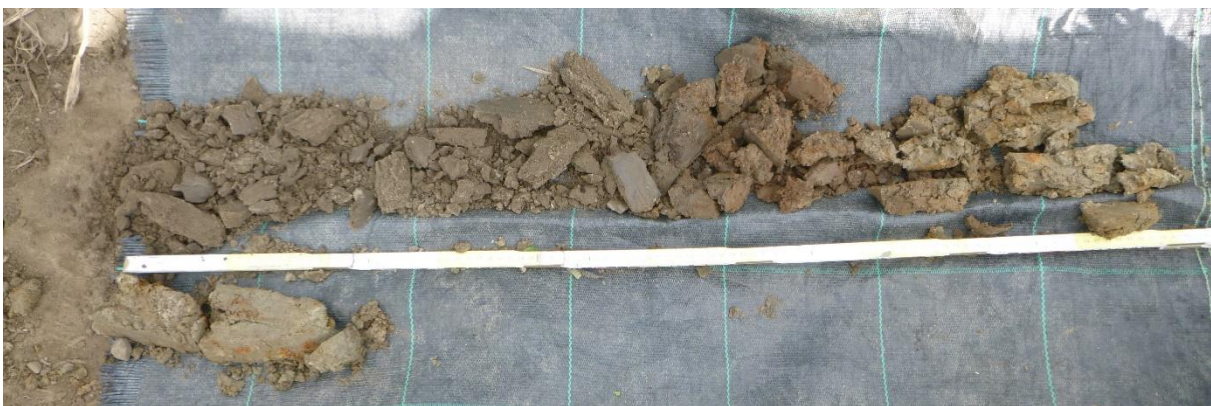
Figuur 59: Overzichtsfoto van boring BP22, uitgelegd van links naar rechts en van boven naar onder. Deze foto is representatief voor boringen BP21 en BP22.
