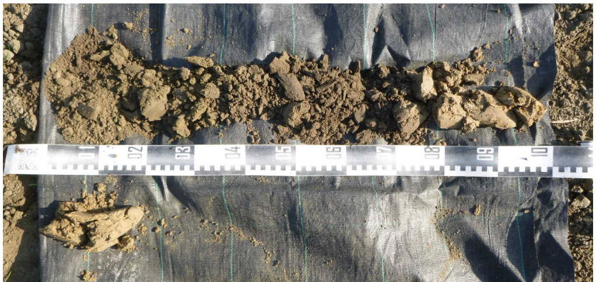
Figuur 56: Overzichtsfoto van boring BP16, uitgelegd van links naar rechts en van boven naar onder. Deze foto is representatief voor boringen BP16 en BP20.
