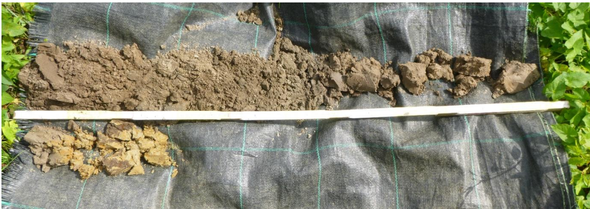
Figuur 49: Overzichtsfoto van boring BP26, uitgelegd van links naar rechts en van boven naar onder. Deze foto is representatief voor boringen BP26 en BP29.
