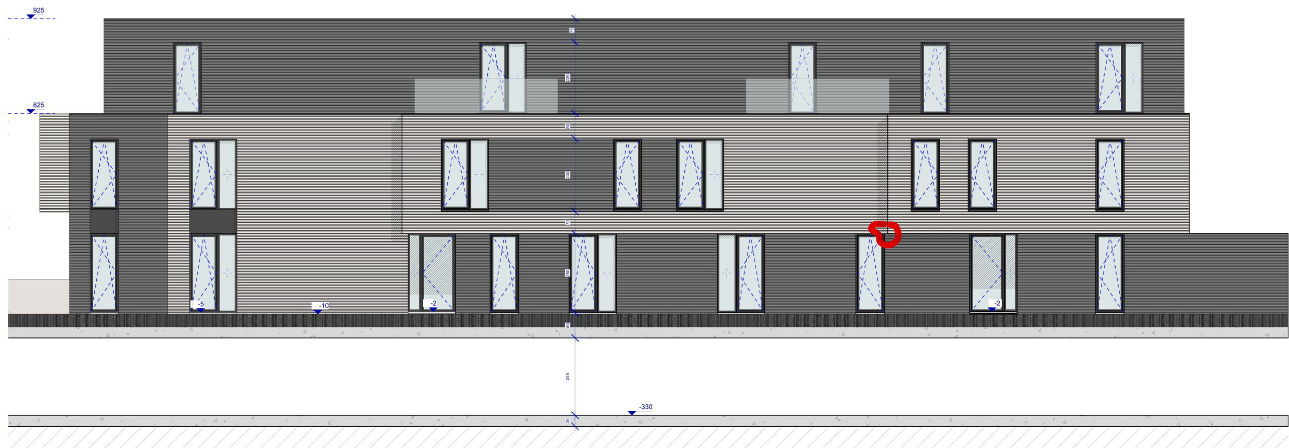
Figuur 7: Zicht op de dwarsdoorsnede van de blok aan de straatzijde: achtergevel. 9
