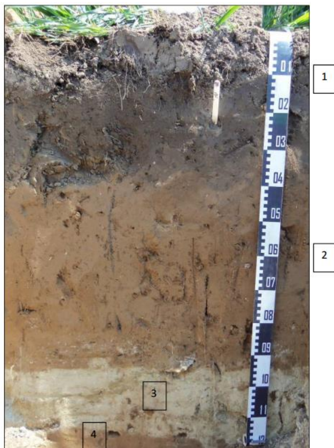
Figuur 24: Referentieprofiel onderzoek Brucargo met antropogene gelaagdheid, waarbij de oorspronkelijke bodemopbouw teruggelegd werd bij opvullen van de groeve 37
