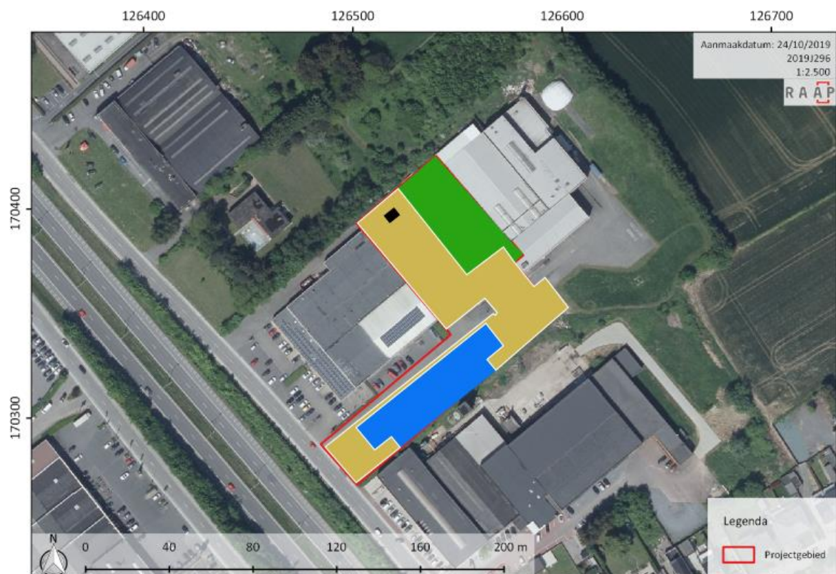
Figuur 1 Luchtfoto met aanduiding van de geplande werken (vereenvoudigde weergave). Blauw: zone nieuw bedrijfsverzamelgebouw, Geel: parking en wegenis, Groen: zone inzaaien, Zwart: te behouden HS-cabine. (bron: AGIV, 2018).
