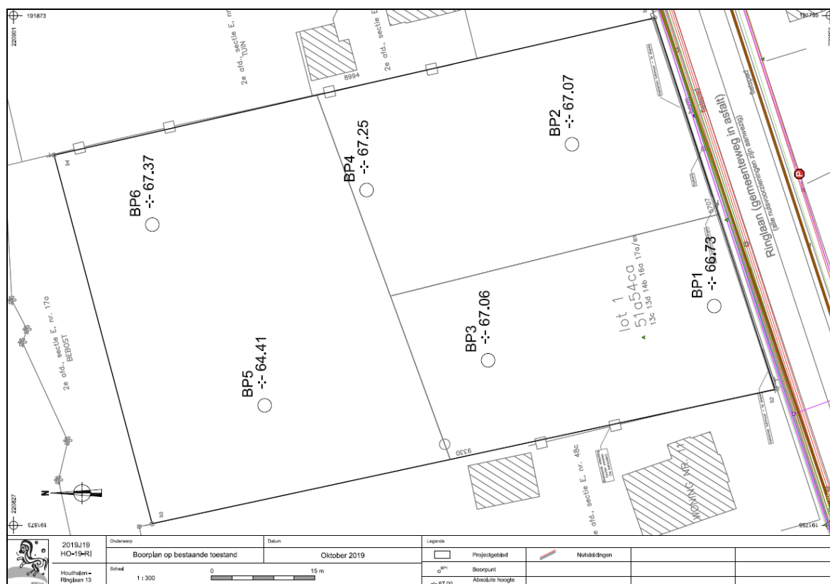
Afb. 28: Boorplan met aanduiding van de boorpunten en het onderzoeksterrein op bestaande toestand (BT) (ARON bvba, digitaal plan, dd. 04/11/2019, aanmaatschaal 1.300, 2019J19).
