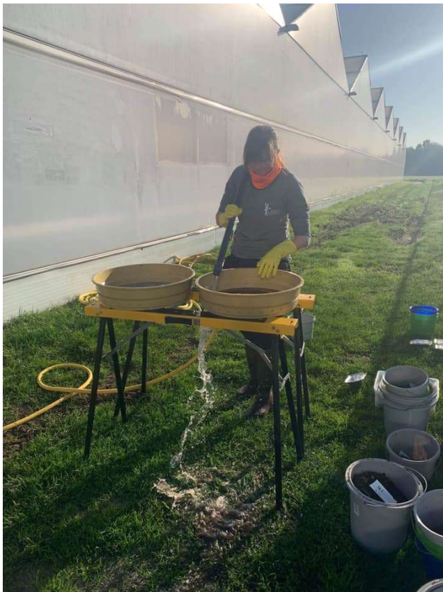
Figuur 16. Uitzeven van de boringen per bodemhorizont. ©LARES
