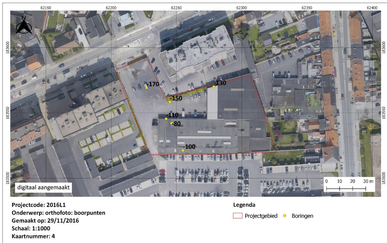
Figuur 7: het projectgebied op de orthofoto met aanduiding van de boorpunten van het oriënterend booronderzoek en de diepten van verstoring (©Geopunt)
