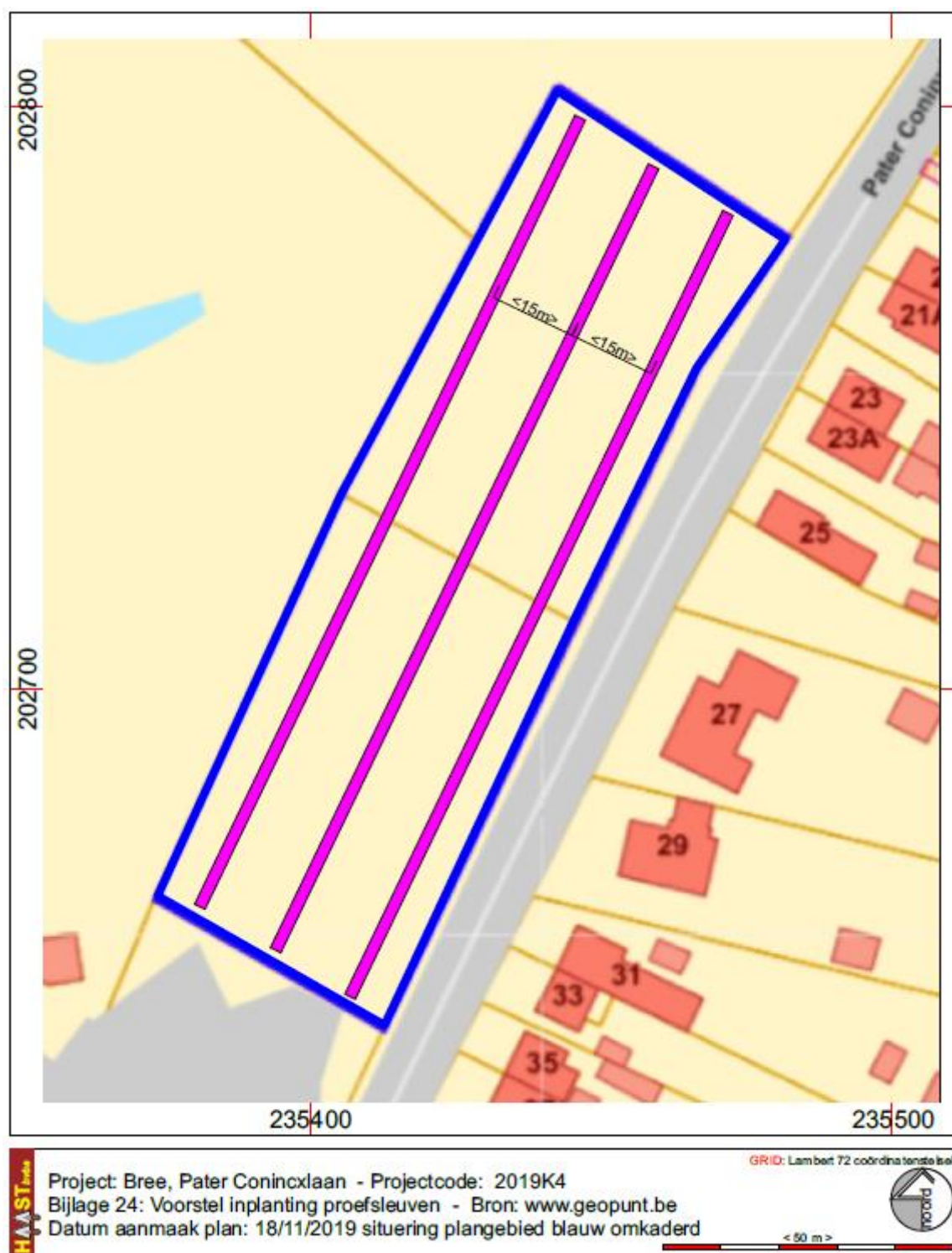
Fig. 26: Voorstel van inplanting van de proefsleuven.
