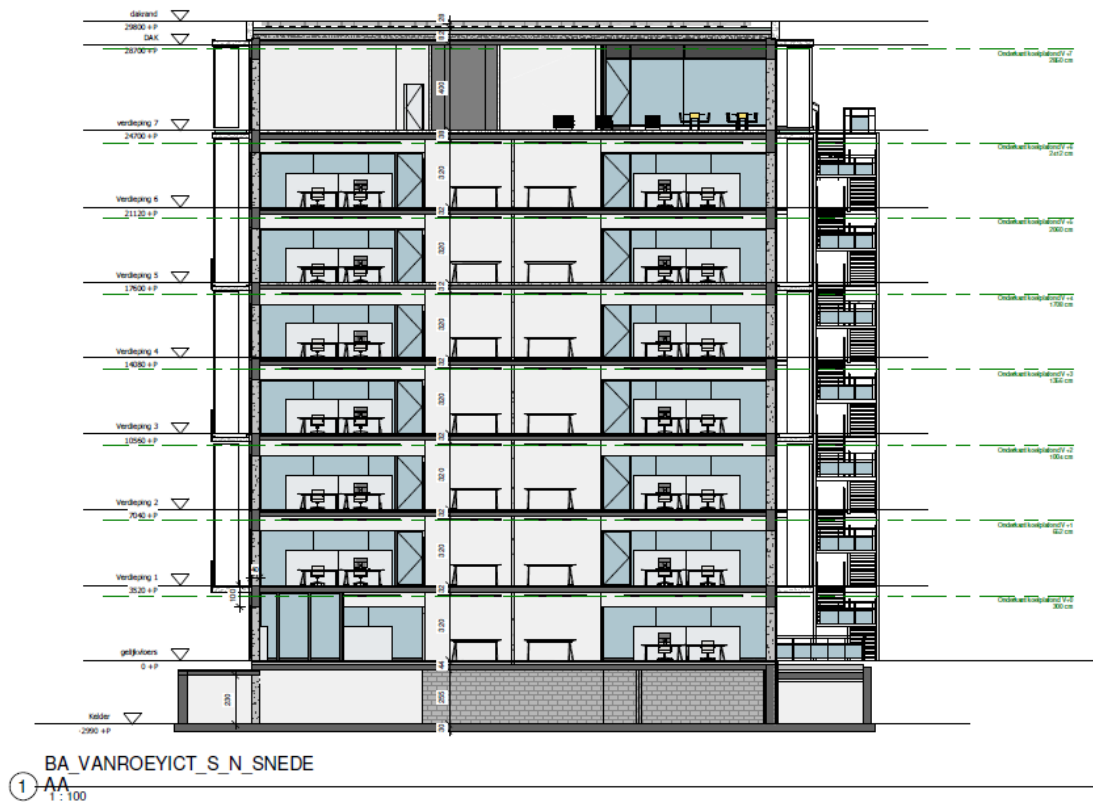
Figuur 11: Doorsnede van toekomstig gebouw 10
