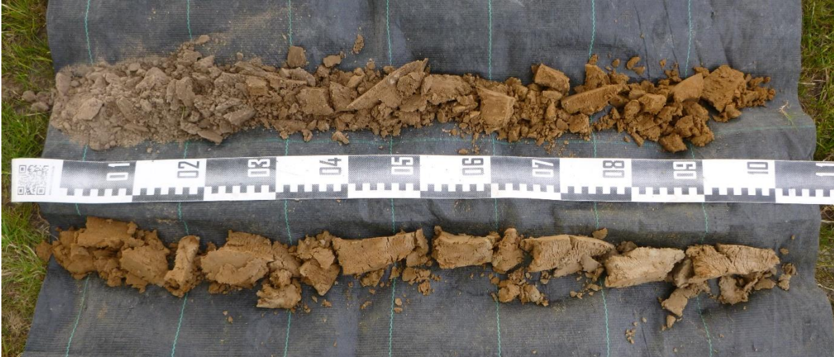
Figuur 41: Overzichtsfoto van boring BP9, uitgelegd van links naar rechts en van boven naar onder. Deze foto is representatief voor boringen BP8 en BP9.
