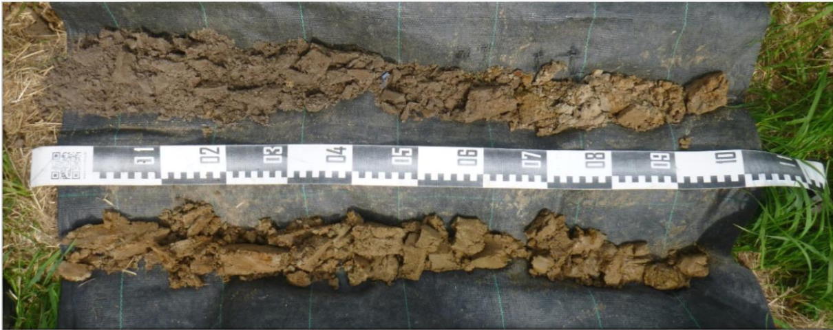
Figuur 43: Overzichtsfoto van boring BP13, uitgelegd van links naar rechts en van boven naar onder. Deze foto is representatief voor boringen BP12, BP13 en BP14.
