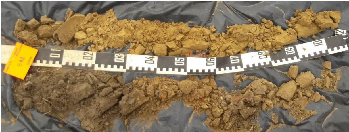
Foto 7 : Boring 2 van 0 (linksonder) naar 200 cm (rechtsboven) beneden het maaiveld
