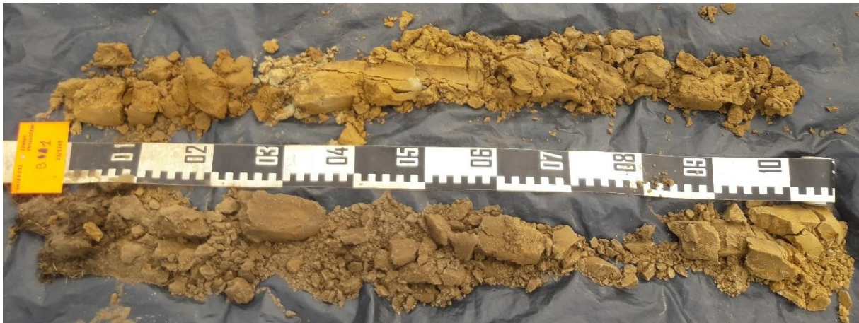
Foto 6 : Boring 1 van 0 (linksonder) naar 200 cm (rechtsboven) beneden het maaiveld
