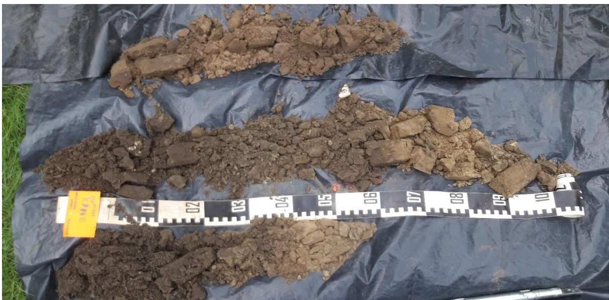
Foto 8 : Boring 3A (onder) van 0 (linksonder) naar 60 cm (midden onder) beneden het maaiveld. Boring 3B (boven) van 0 (links midden) naar 160 cm (midden boven) beneden het maaiveld
