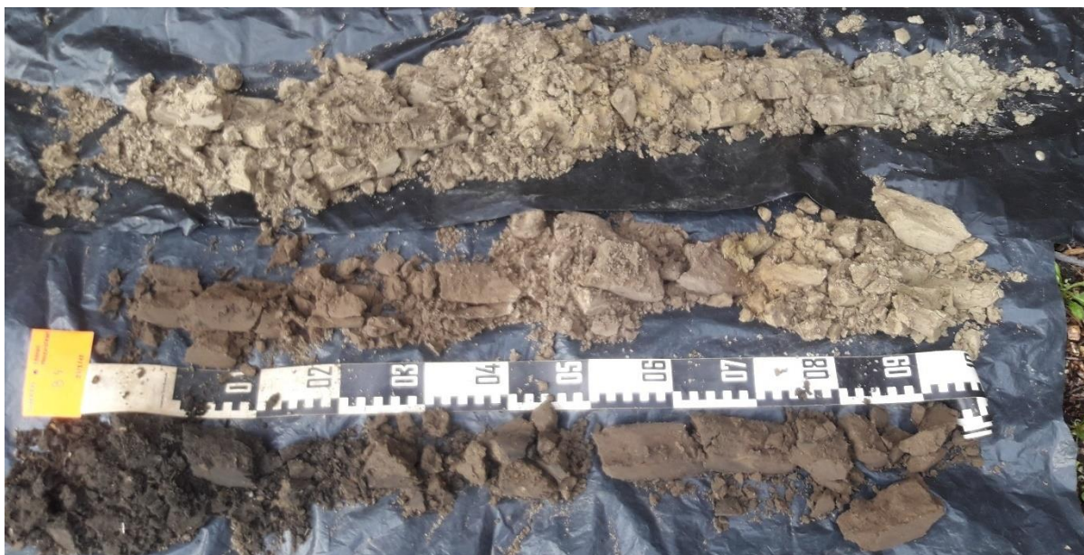
Foto 9: Boring 4 van 0 (linksonder) naar 300 cm (rechtsboven) beneden het maaiveld
