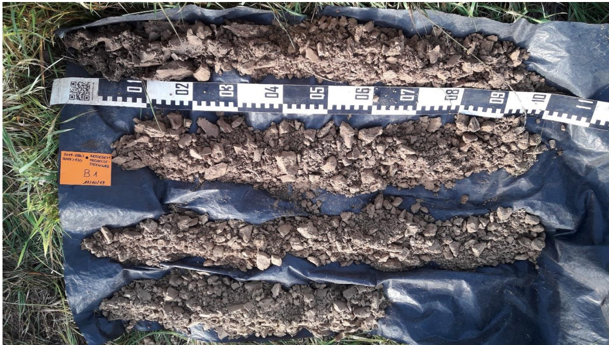
Figuur 13 : Boring 1, van 0 cm (linksboven) tot 370 cm (rechtsonder) beneden het maaiveld. (©BAAC)
