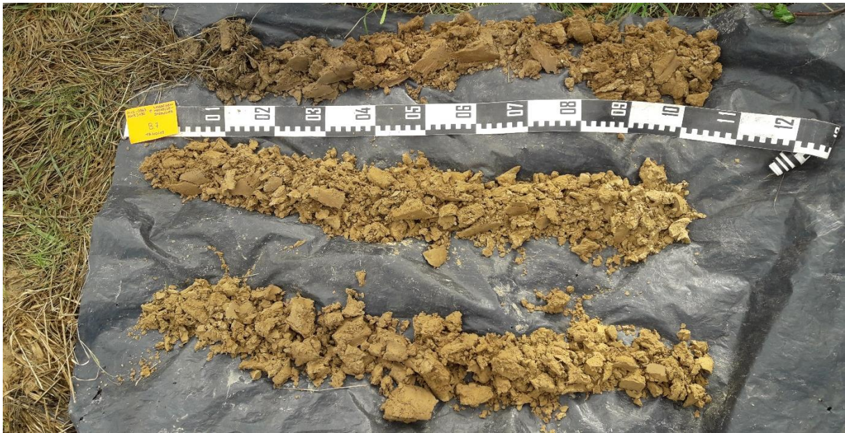
Figuur 19 : Boring 7, van 0 cm (linksboven) tot 300 cm (rechtsonder) beneden het maaiveld. (©BAAC)
