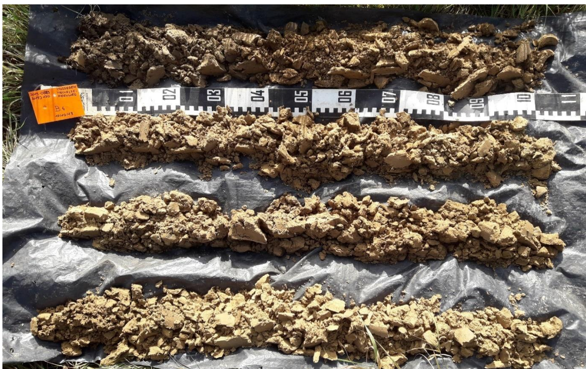
Figuur 16 : Boring 4, van 0 cm (linksboven) tot 400 cm (rechtsonder) beneden het maaiveld. (©BAAC)
