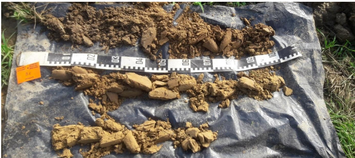
Figuur 18 : Boring 6, van 0 cm (linksboven) tot 270 cm (rechtsonder) beneden het maaiveld. (©BAAC)
