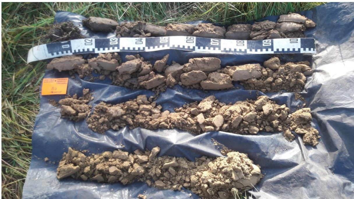
Figuur 14 : Boring 2, van 0 cm (linksboven) tot 370 cm (rechtsonder) beneden het maaiveld. (©BAAC)
