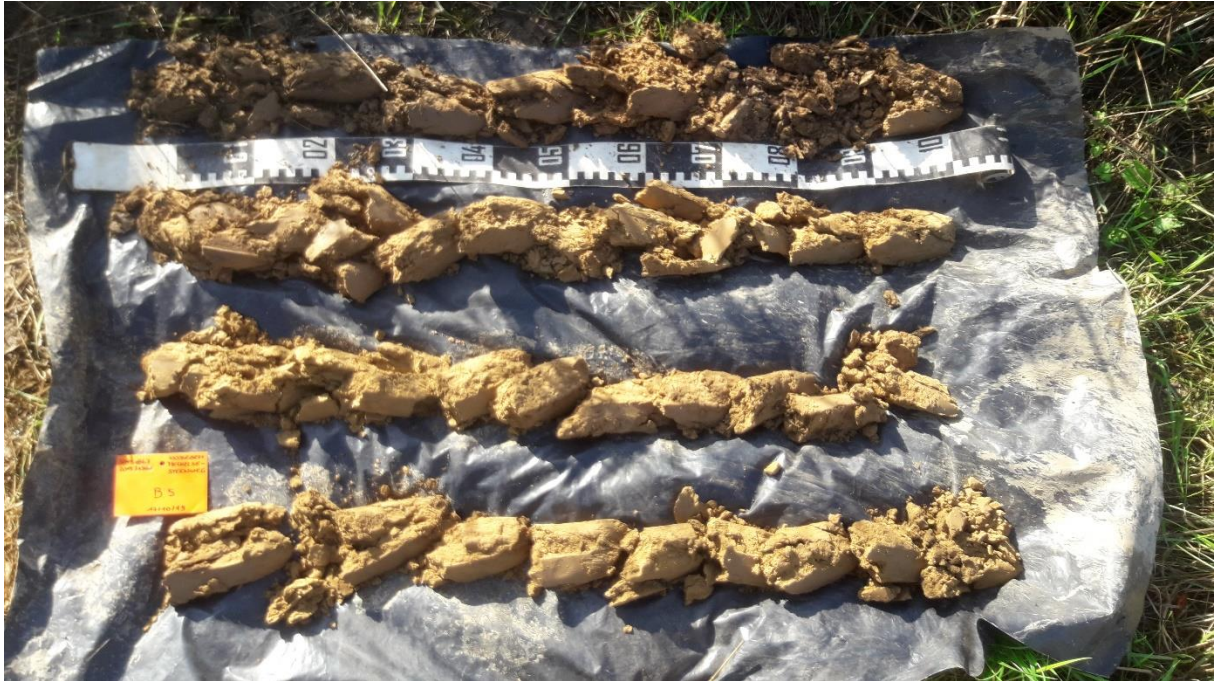
Figuur 17 : Boring 5, van 0 cm (linksboven) tot 400 cm (rechtsonder) beneden het maaiveld. (©BAAC)
