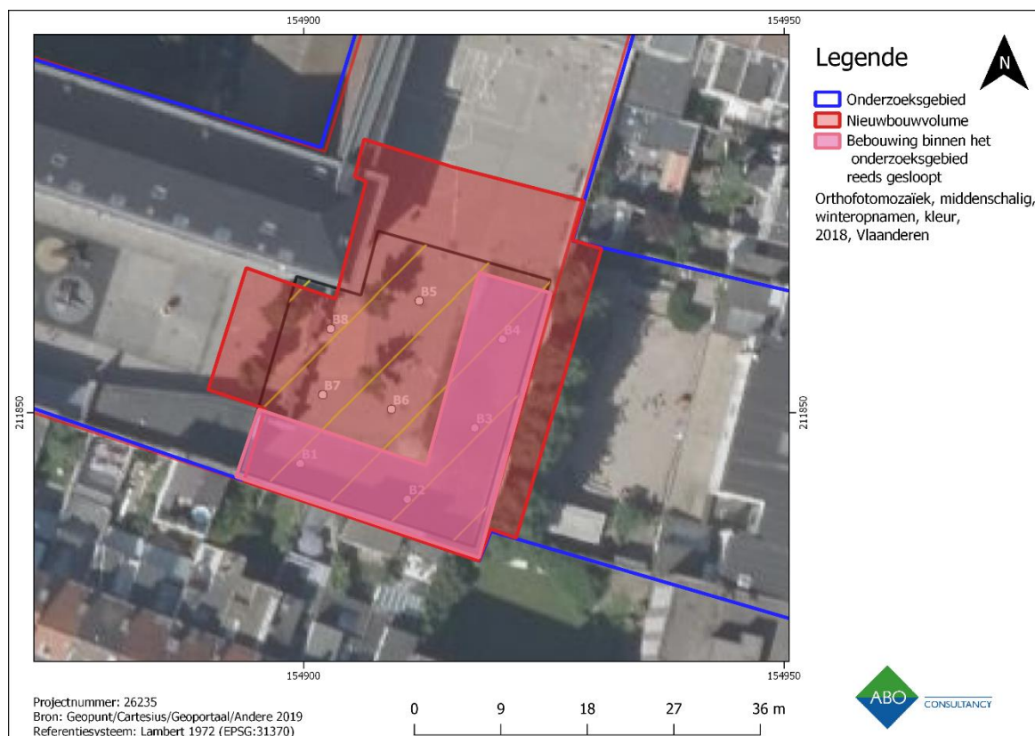
Figuur 3: De boringen zichtbaar in het (reeds) gesloopte gebouw (roze) en in de verhardingen (de rest).
