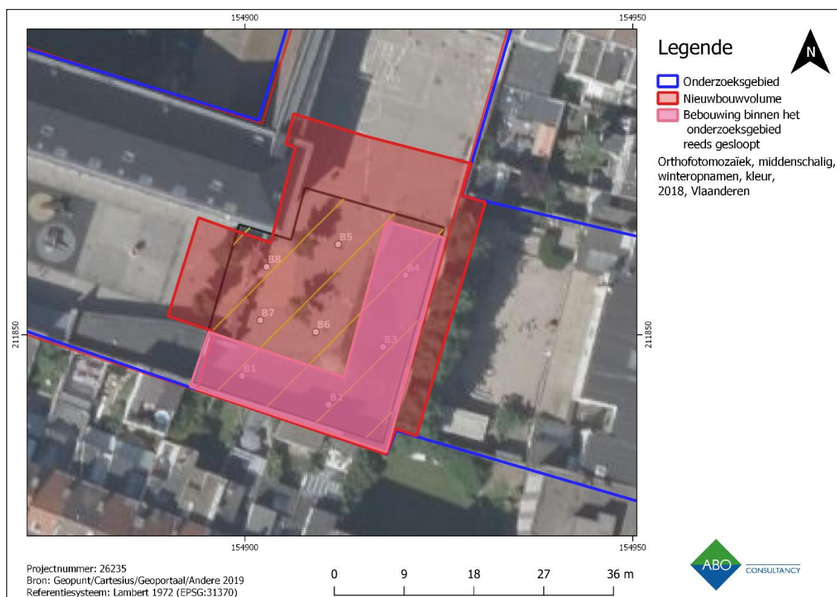
Figuur 19: De boringen zichtbaar in het (reeds) gesloopte gebouw (roze) en in de verhardingen (de rest).
