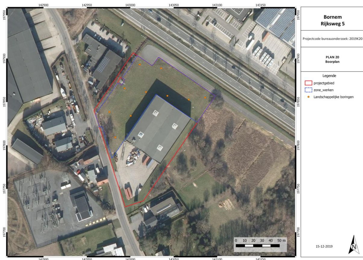
Figuur 2: Voorstel boorgrid. © Devroe bvba 2019
