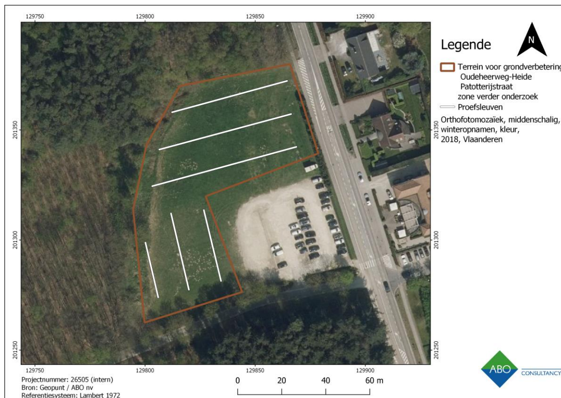
Figuur 28: Luchtfoto 2018 met aanduiding van het indicatieve proefsleuvenplan binnen het terrein voor grondverbetering aan de Oudeheerweg-Heide/Patotterijstraat te Waasmunster.
