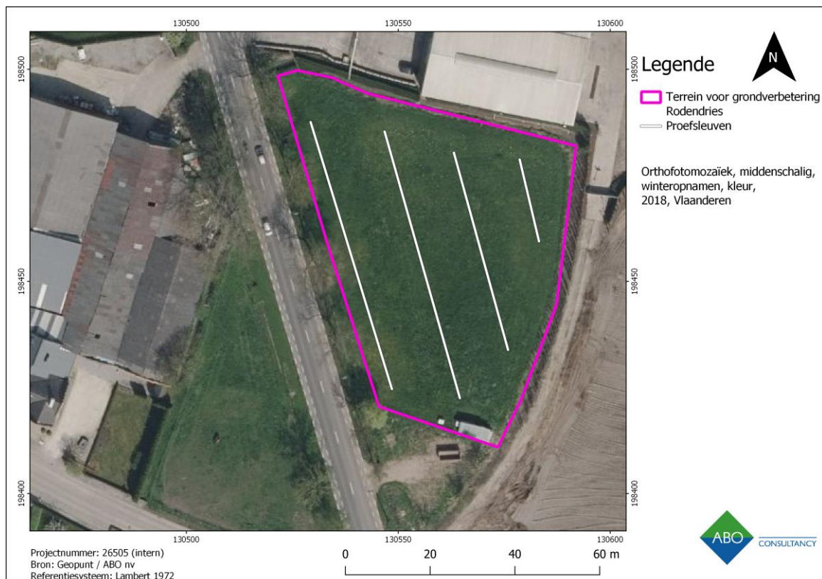
Figuur 32: Luchtfoto (2018) met aanduiding van het indicatieve proefsleuvenplan binnen het terrein voor grondverbetering (Rodendries) te Waasmunster.
