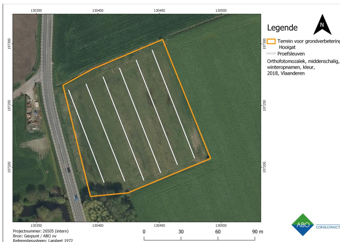
Figuur 34: Luchtfoto (2018) met aanduiding van het indicatieve proefsleuvenplan binnen het terrein voor grondverbetering (Hooigat) te Waasmunster.
