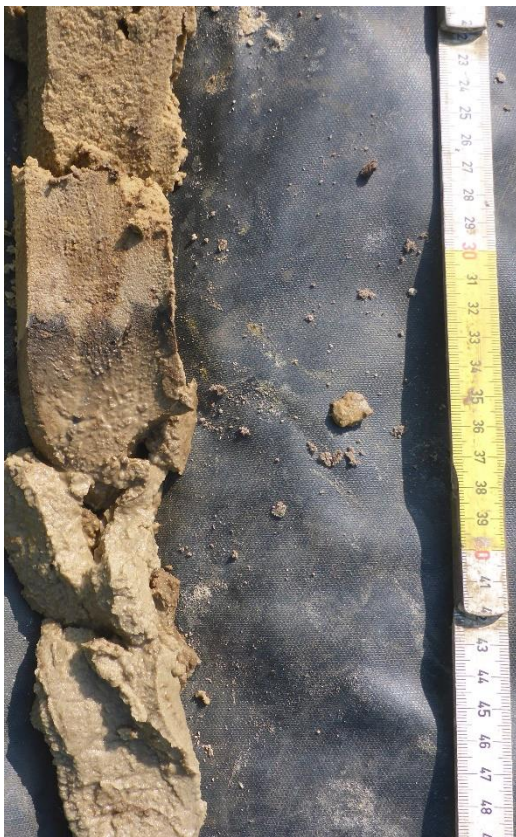
Figuur 28: Duidelijke paleobodem in boring B124 (GATE).
