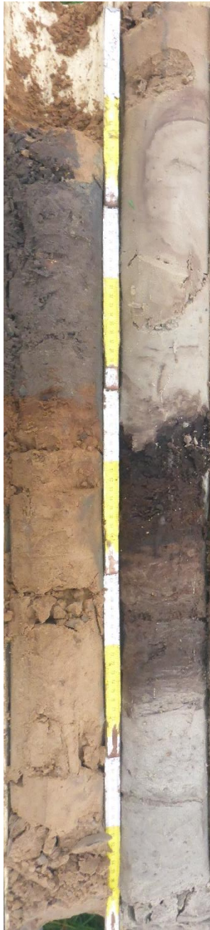
Figuur 54: Boring 143 met begraven venige moerasafzettingen op een diepte van 150 -tot 180 cm t.o.v. het maaiveld (GATE).
