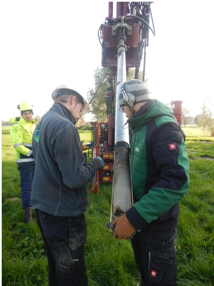
Figuur 45: Het uitduwen van het opgeboorde sediment (GATE).
