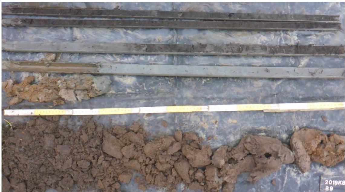
Figuur 55: boring 9 met fluvio-lacustriene afzettingen vanaf 445 cm.
