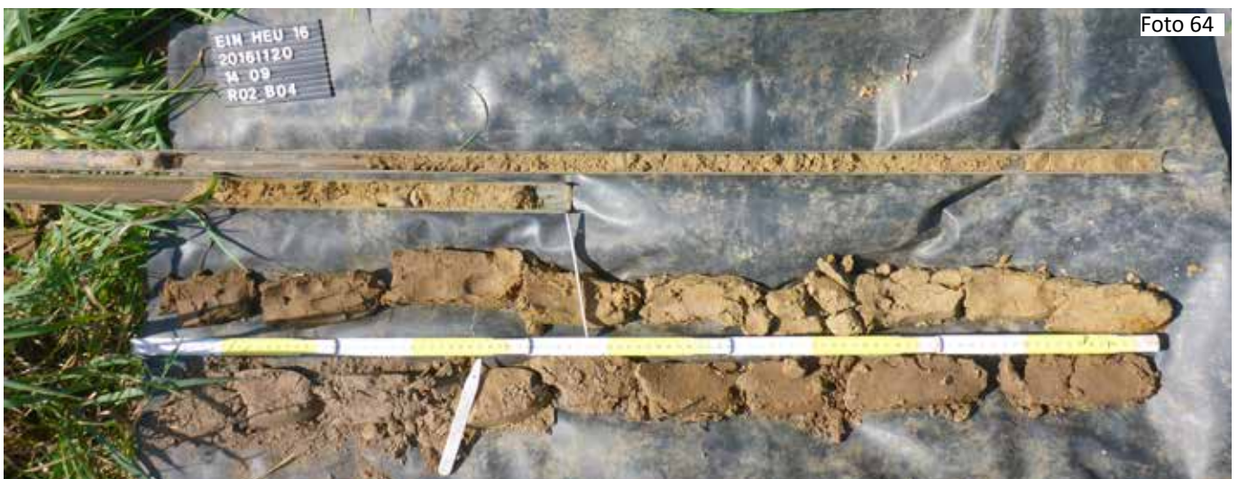
Figuur 64: Het boorprofiel van boring R02B04 met aanduiding van de horizonten (© F. Cruz)
