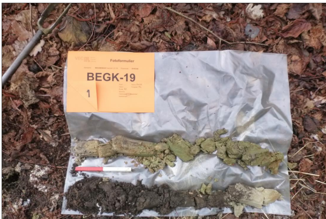
Afb. 14. Boring 1 uitgelegd van links naar rechts en van onder naar boven.
