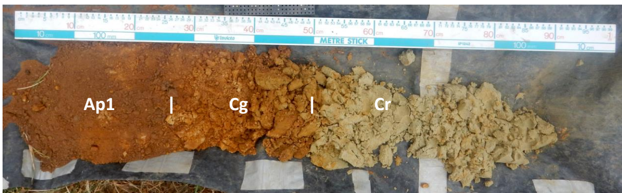
Figuur 37: Foto van uitgelegd boorprofiel 112. De bovengrond kon hier bijna niet worden doorboord door indroging van het materiaal.
