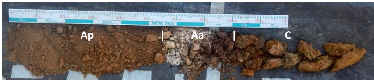
Figuur 32: Foto van uitgelegd boorprofiel 103, waar de antropogene lagen zich duidelijk aftekenen (Aa-horizont).
