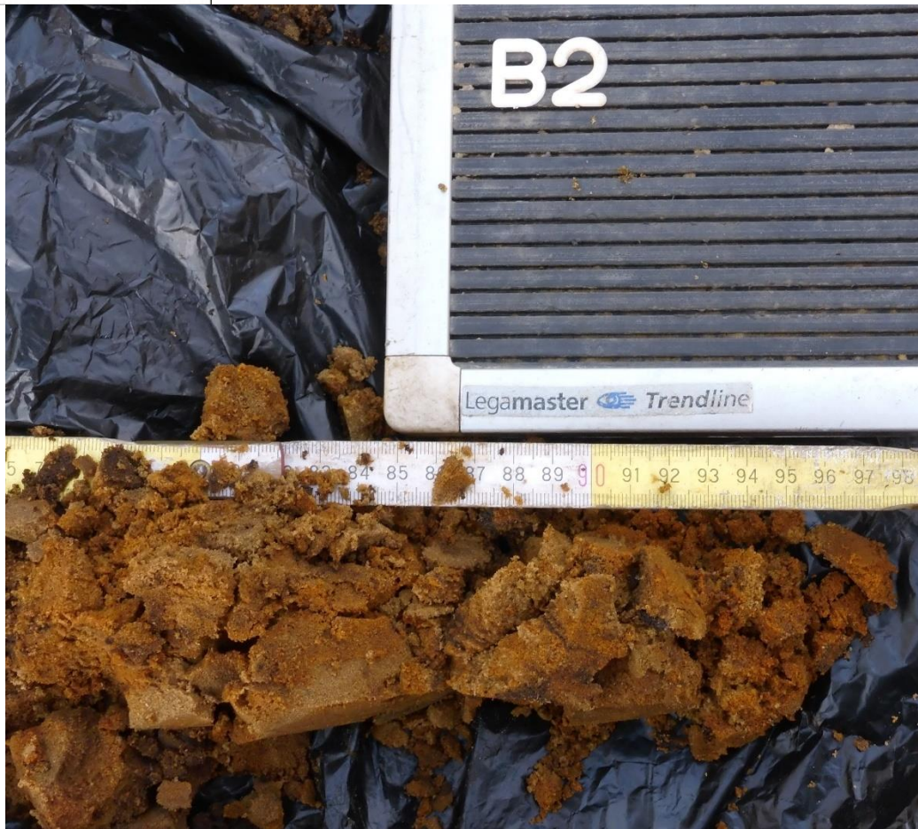
Figuur 14: Detail van de sterk geaderde gemengde C-horizont in boring 2
