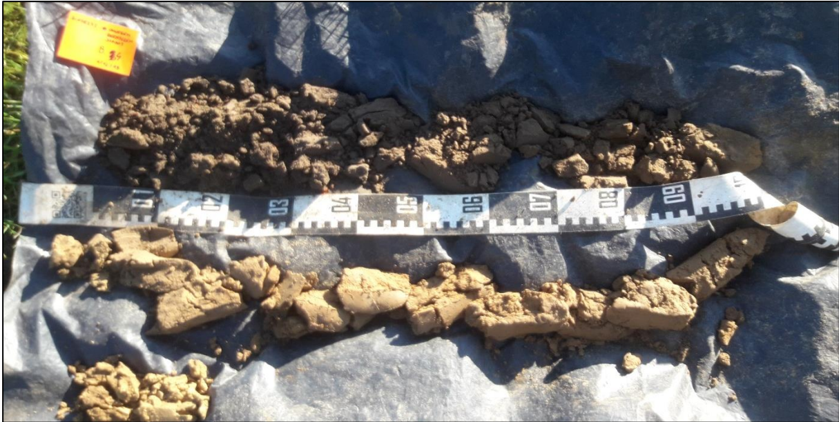
Figuur 6 : Boring 4, van 0 cm (linksboven) tot 220 cm (linksonder) beneden het maaiveld.
