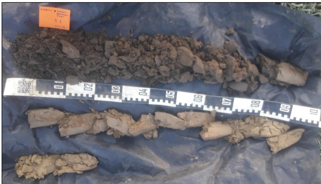
Figuur 3 : Boring 1, van 0 cm (linksboven) tot 225 cm (linksonder) beneden het maaiveld.
