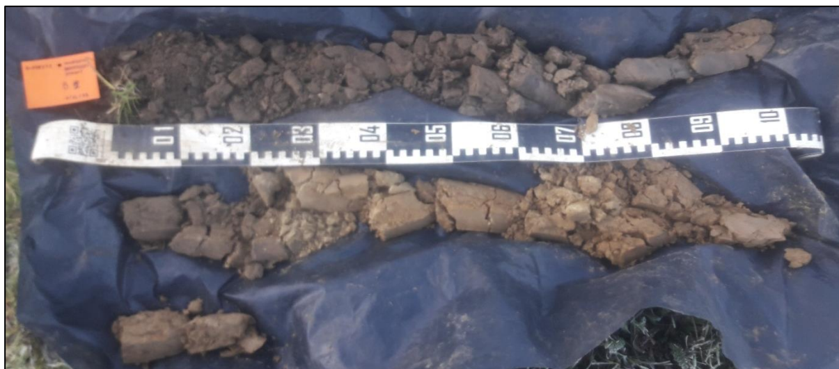
Figuur 4 : Boring 2, van 0 cm (linksboven) tot 220 cm (linksonder) beneden het maaiveld.
