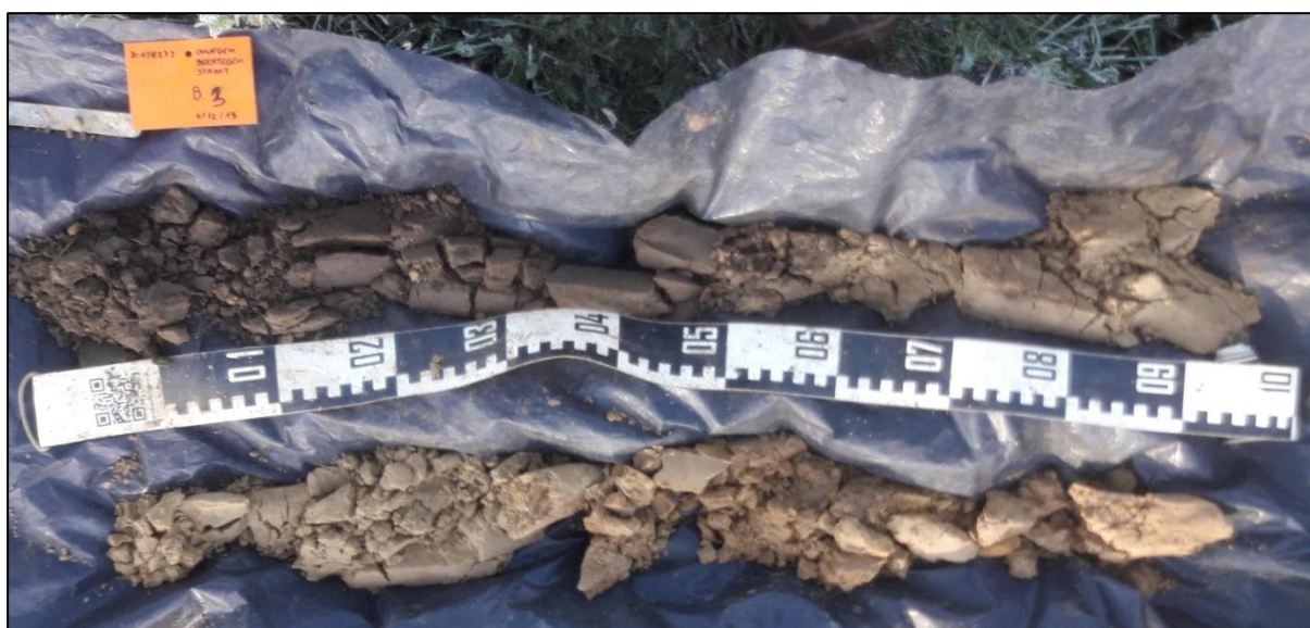
Figuur 5 : Boring 3, van 0 cm (linksboven) tot 200 cm (linksonder) beneden het maaiveld.
