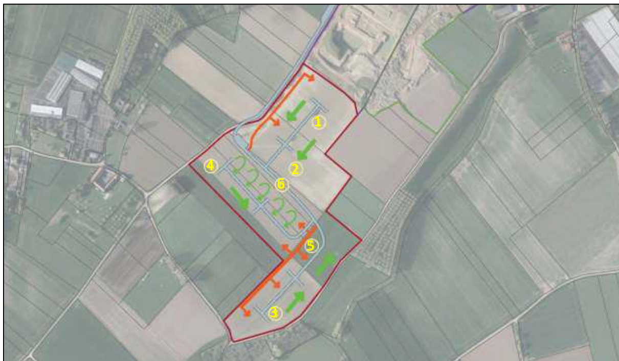
Afb. 4: Voorlopige faseringsplan met opeenvolgende fases (geel), ontginningsrichting (groen), werfpiste voor uitgraving en wielwasinstallatie (blauw) en werfpiste en richting voor navulling (rood) (MER, Fig. 3.7, 53).
