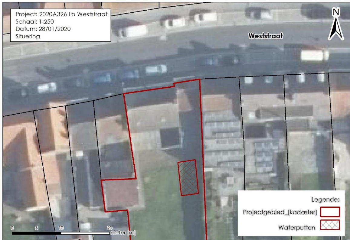
Figuur 2: Kadastraal plangebied langs de Weststraat nr. 22 met aanduiding zone toekomstige regenwaterputten [24.5 m 2 ] in de tuin
