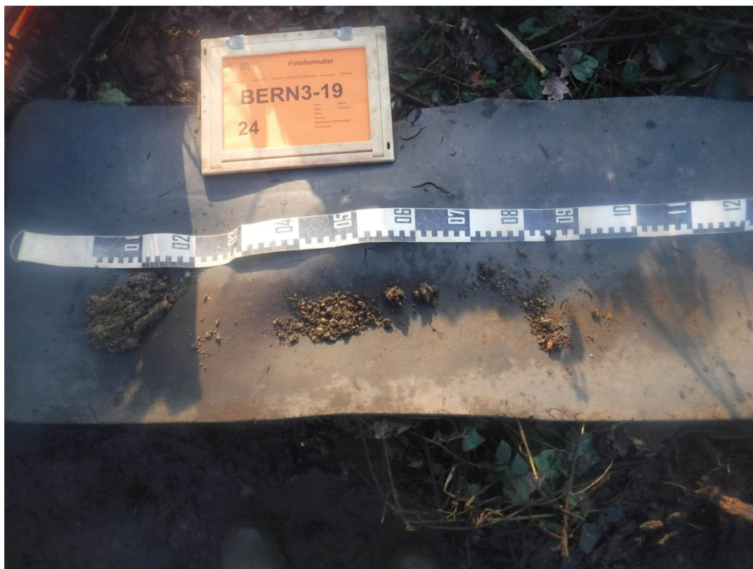
Afb. 12. Foto van boring 24, gestuit na meerdere pogingen. Een voorbeeld van een gestuite boring.
