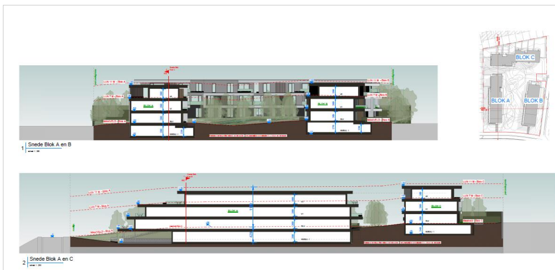
Figuur 9: Plan van doorsnede van blok A, B en C (APART real estate nv, 2017)
