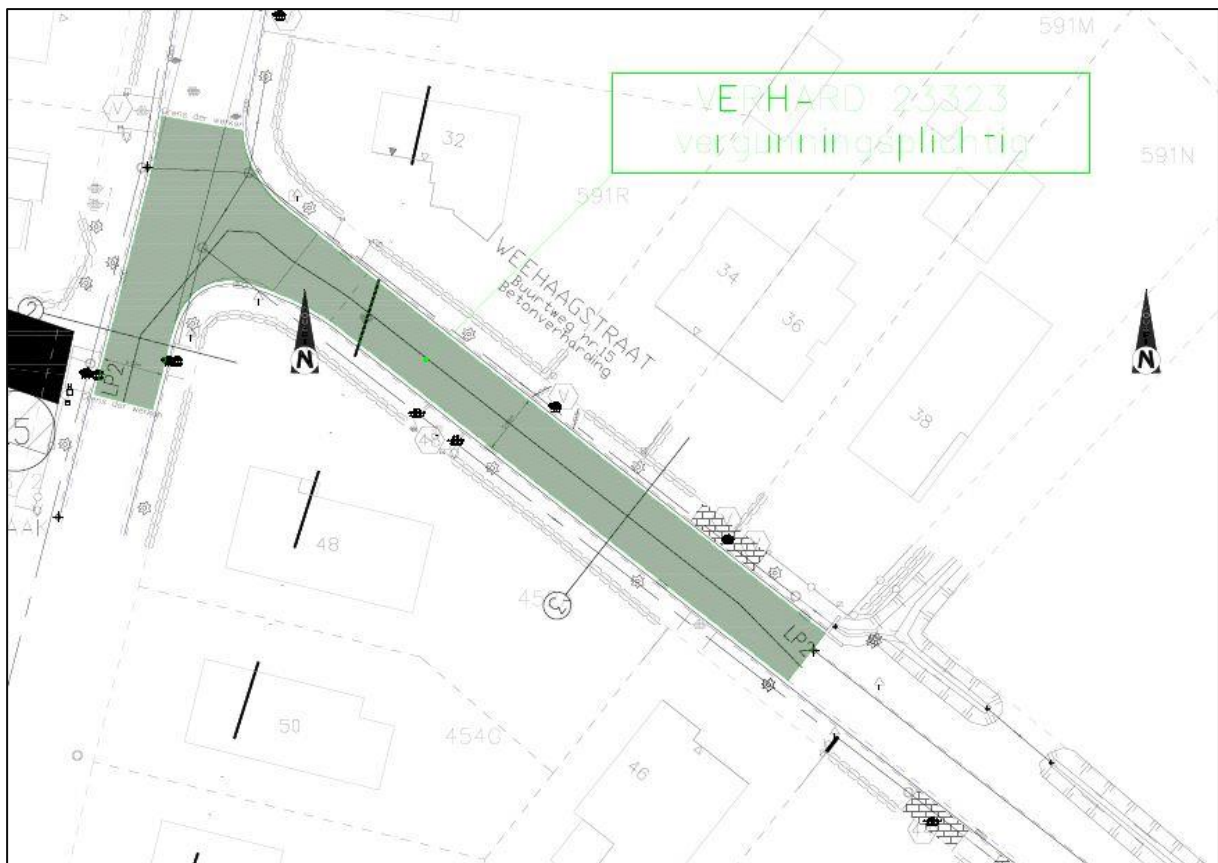
Figuur 9: Een deel van de Buurtweg nr. 15 wordt opnieuw verhard (Initiatiefnemer 2020).
