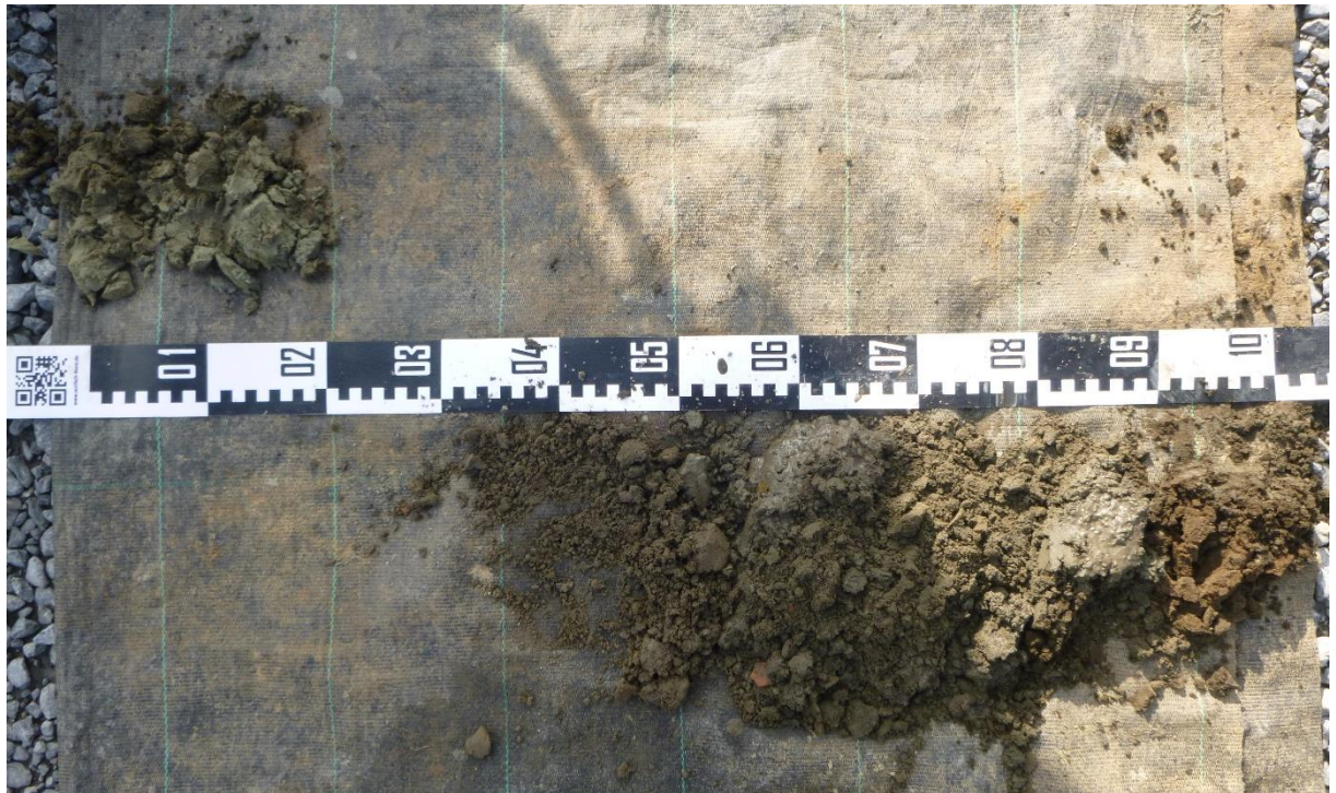
Figuur 27.: Overzichtsfoto van boring BP26, uitgelegd van links naar rechts en van onder naar boven. De afgegraven verharding is niet zichtbaar op deze foto. Deze foto is representatief voor boringen BP5, BP7, BP18 en BP26.
