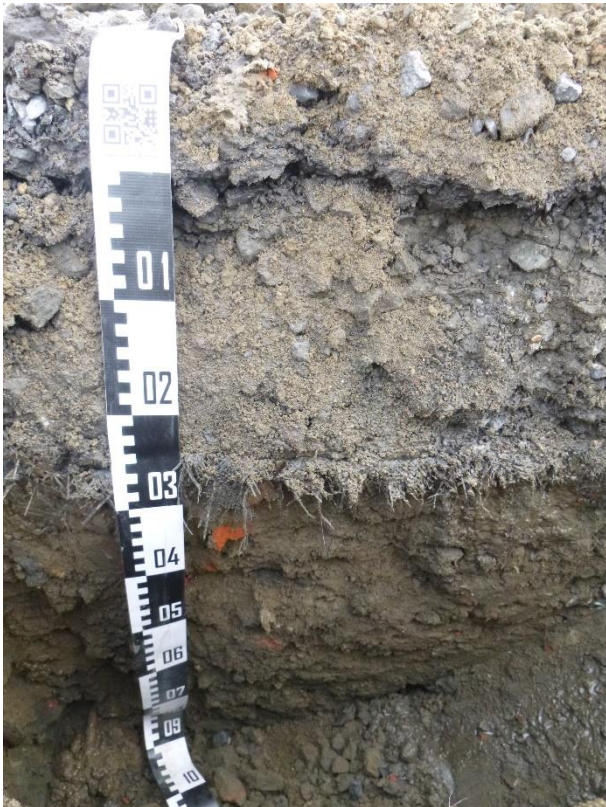
Figuur 29.: Uitgraving van de verharding en dens puinpakket in profiel ter hoogte van boorpunt BP5.
