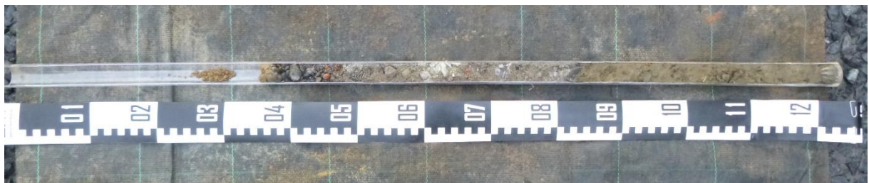
Figuur 31.: Overzichtsfoto van boring BP19, uitgelegd van links naar rechts en van boven naar onder. Deze foto is representatief voor boringen BP12, BP17, BP19 en BP23.
