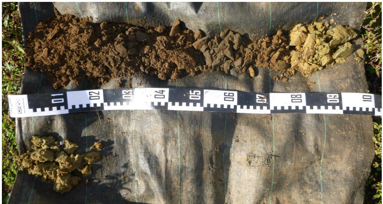
Figuur 34.: Overzichtsfoto van boring BP25, uitgelegd van links naar rechts en van boven naar onder. Deze foto is representatief voor boringen BP20, BP24 en BP25.
