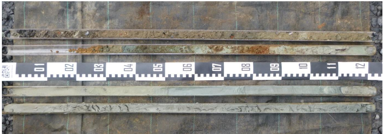
Figuur 30.: Overzichtsfoto van boring BP28, uitgelegd van links naar rechts en van boven naar onder.
