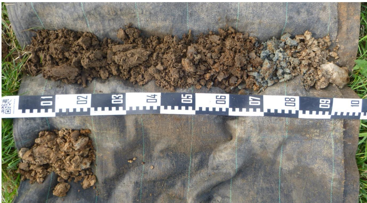
Figuur 36.: Overzichtsfoto van boring BP22, uitgelegd van links naar rechts en van boven naar onder.
