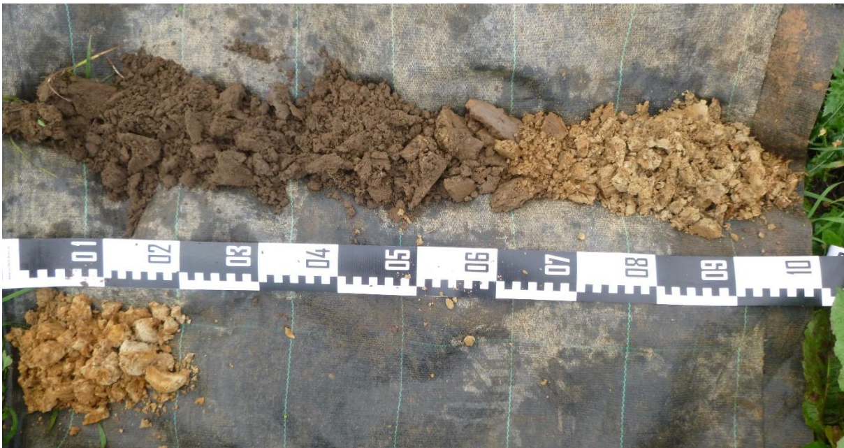
Figuur 32.: Overzichtsfoto van boring BP9, uitgelegd van links naar rechts en van boven naar onder. Deze foto is representatief voor boringen BP3, BP4, BP9, BP14 en BP21.
