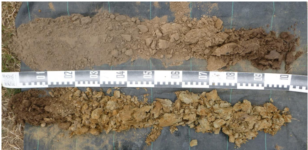
Figuur 3: Overzichtsfoto van boring BP1, uitgelegd van links naar rechts en van boven naar onder. Deze foto is representatief voor boringen BP1 en BP2.
