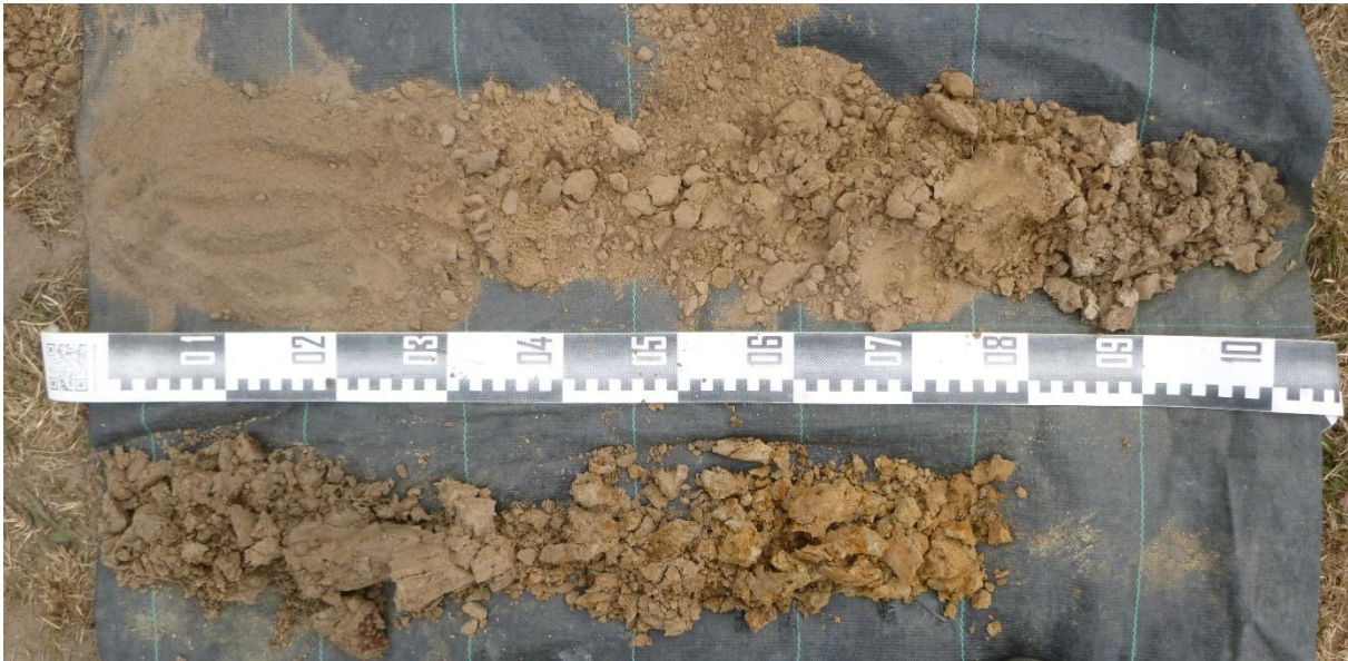
Figuur 4: Overzichtsfoto van boring BP6, uitgelegd van links naar rechts en van boven naar onder.
