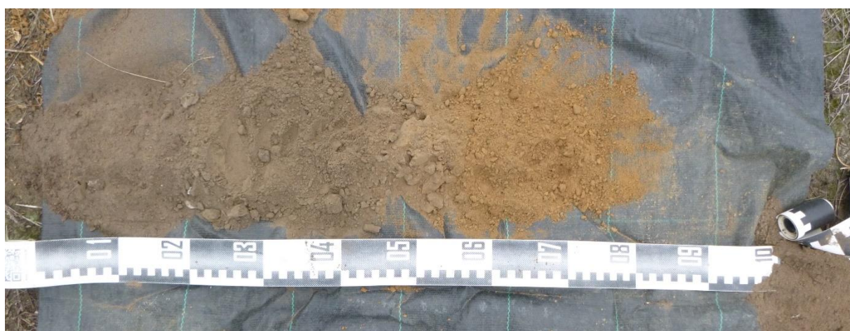
Figuur 11: Overzichtsfoto van boring BP9, uitgelegd van links naar rechts.
