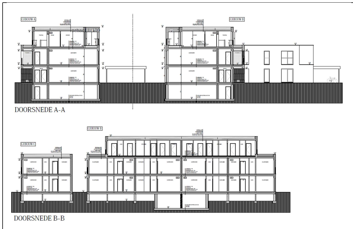
Figuur 12. Doorsnede nieuwbouw.
