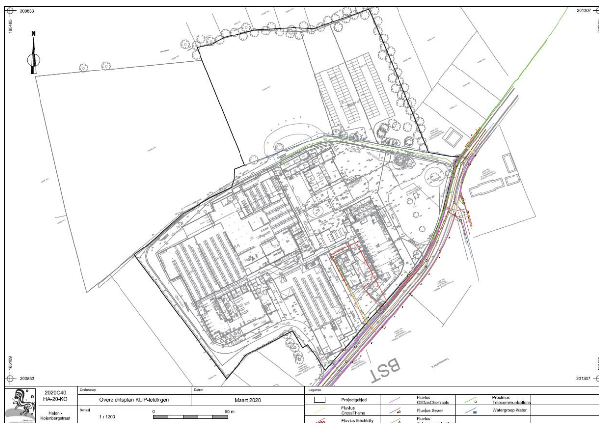
Afb. 33: Overzicht aanwezige nutsleidingen op het projectgebied (Bron: KLIP, digitaal plan, dd 11/03/2020, aanmaatschaal 1.1200, 2020C40).
