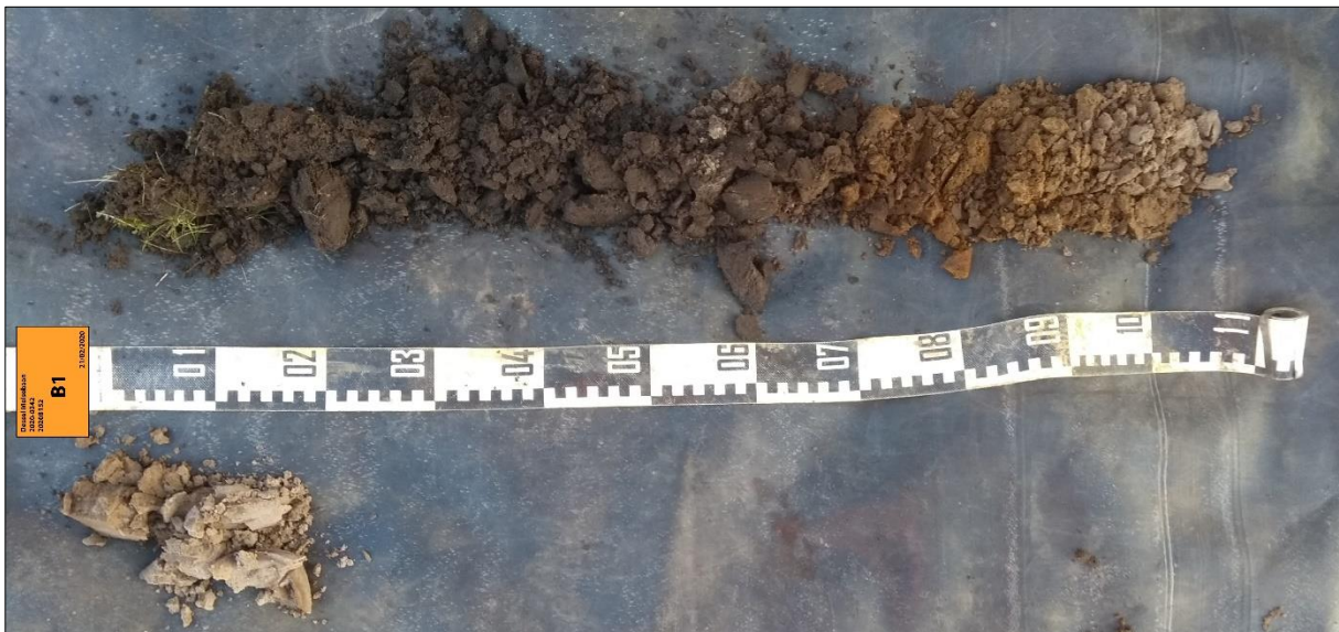
Figuur 3: Boring 1 van 0 cm links boven tot 120 cm links beneden.
