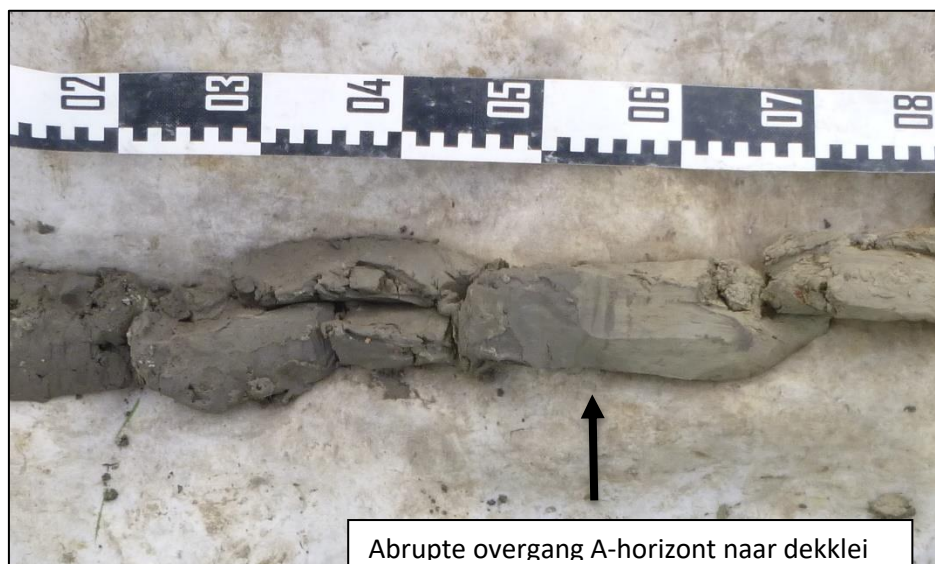
Figuur 60: Detailfoto van de overgang van A-horizont naar de dekklei (ABO nv 2020)
