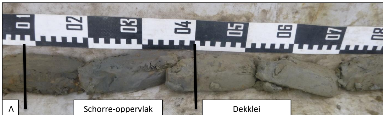
Figuur 55: Detail uit boring 1 met overgang van A-horizont naar het schorre-oppervlak met daaronder dekklei (ABO nv 2020)
