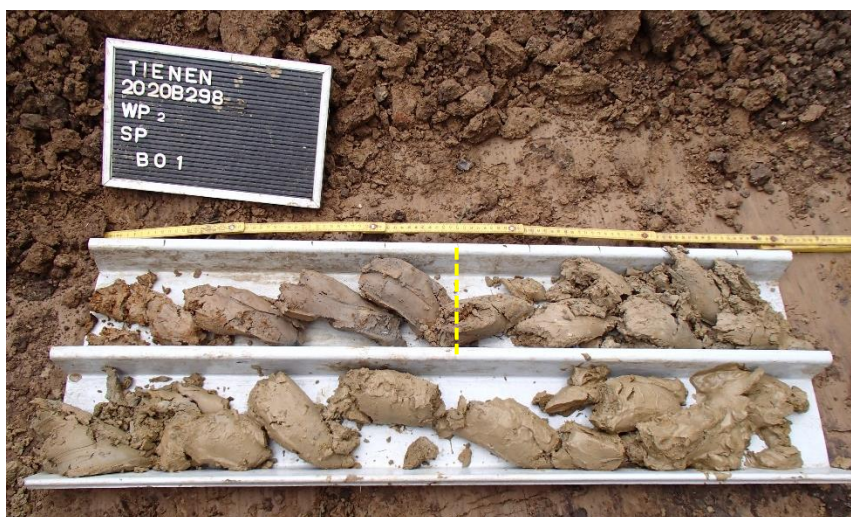
Figuur 12. Zicht op B01 met aanduiding van de grens tussen de fluviatiele afzetting en het onderliggend substraat van de Brabantleem (gele stippellijn).
