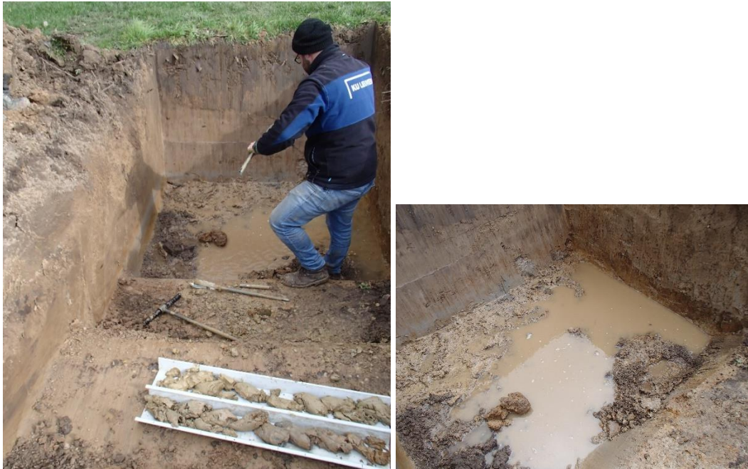
Figuur 8. Werkfoto's van de boring in WP2, waar de profielput zich al snel vulde met grondwater.
