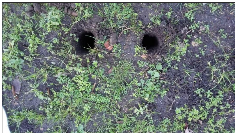
Figuur 50: Twee pogingen gestaakte boring 5 (Abo nv, 2020)
